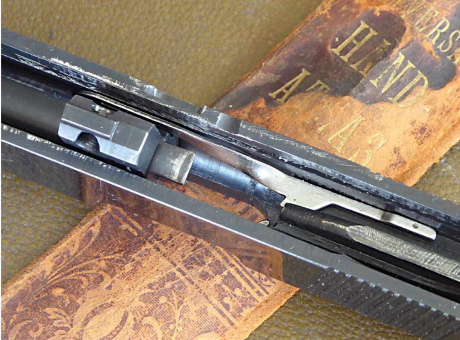
*Verschluss von unten mit Zufuhr rampe des beweglichen Patronenlagers. Oben, glänzend der Ausstoßer*
