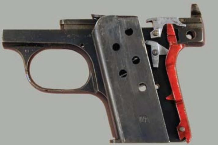
**Abb. 2:** FN 1906, vierte Variante, Lage der Schloßteile bei der Schußauslösung: Abzugstollen abgesenkt, Magazinsicherung deaktiviert, Griffsicherung eingedrückt.
