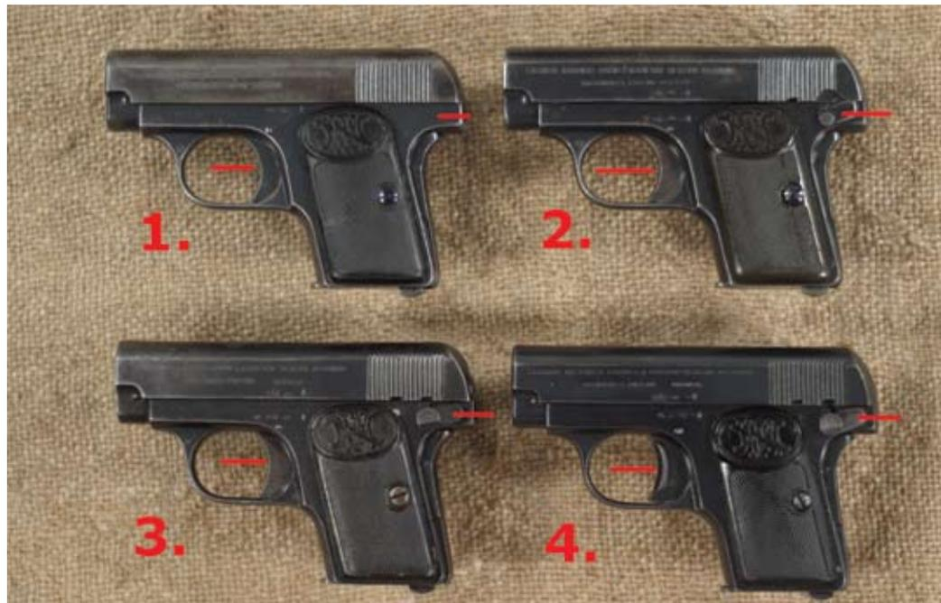
Abb. 1: Äußerliche Unterscheidung der FN 1906 Varianten (Abzugsform und Art der Hebelsicherung); obere Reihe: 1. und 2. Variante, untere Reihe: 3. und 4. Variante
