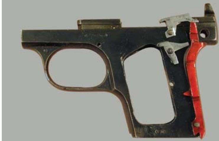
**Abb. 3:** FN 1906, vierte Variante, Lage der Schloßteile bei entferntem Magazin: Magazinsicherung legt die Griffsicherung und damit den Abzugstollen fest.
