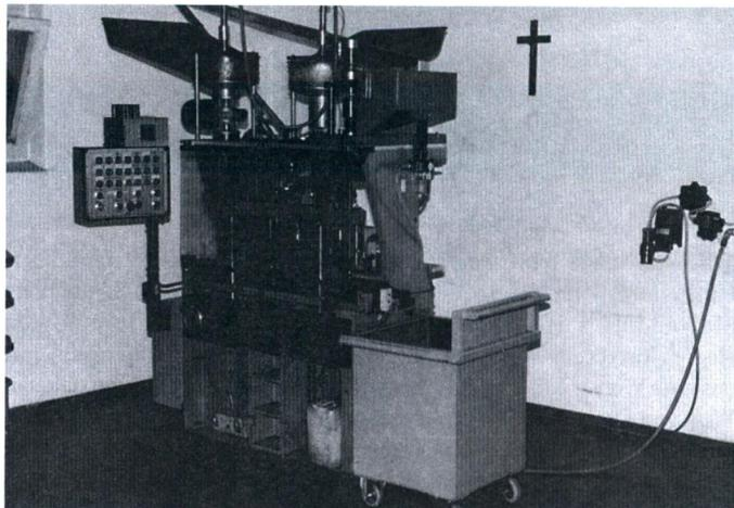
Eine der beiden Schrotpatronenlademaschinen Brunsteiners - Kapazität 4.500 Schuß pro Stunde
