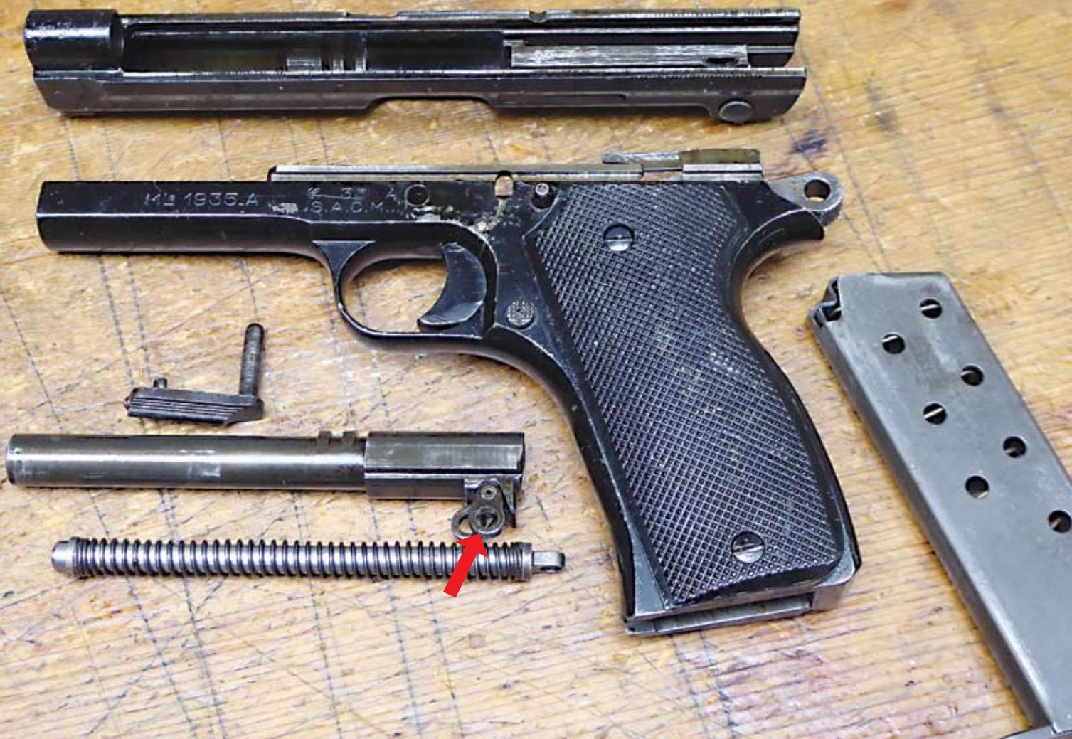
Pistole zum Reinigen zerlegt. Der Pfeil zeigt auf die zwei Kettenglieder
