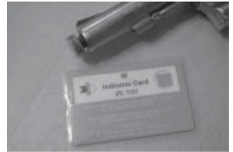
Infrarotpatrone im Revolverlaufe eingesetzt
