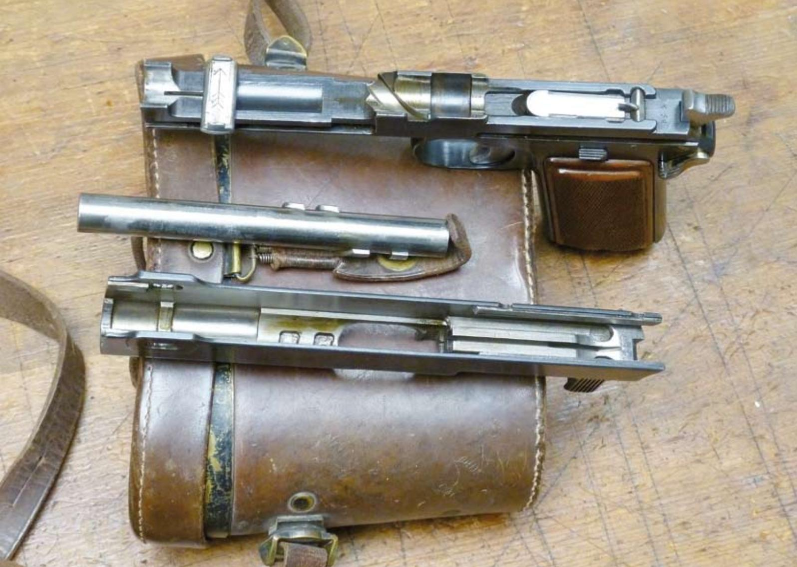
Steyr Pistole zum Reinigen zerlegt, Schlußkeil in korrekter Richtung am Griffstück aufgelegt.
