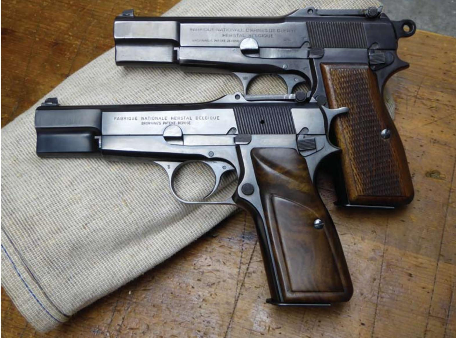
Von oben: HP 35 Fertigung für die Wehrmacht mit Schiebisier und Ringhahn Darunter: HP 35 Fertigung nach 1970, neue Beschriftung mit Schiebisier und Spornhahn
