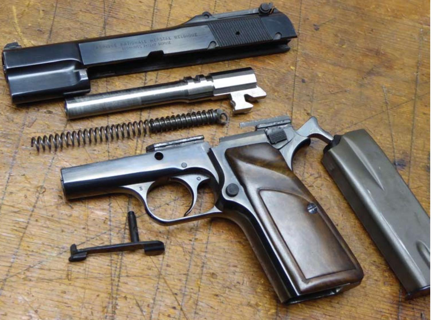
*Zerlegt zum Reinigen*
