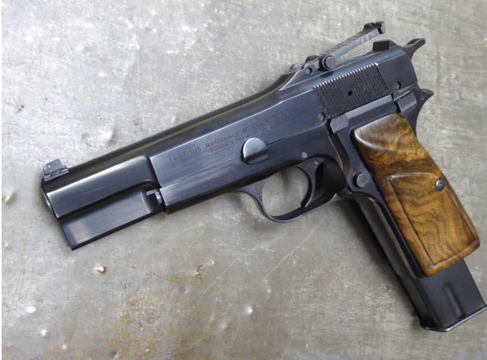
FN HP 35 Modell Capitan mit Schiebevisier Position 500m mit 20 Schuss Magazin. Sondergriffschalen vom Autor handgefertigt
