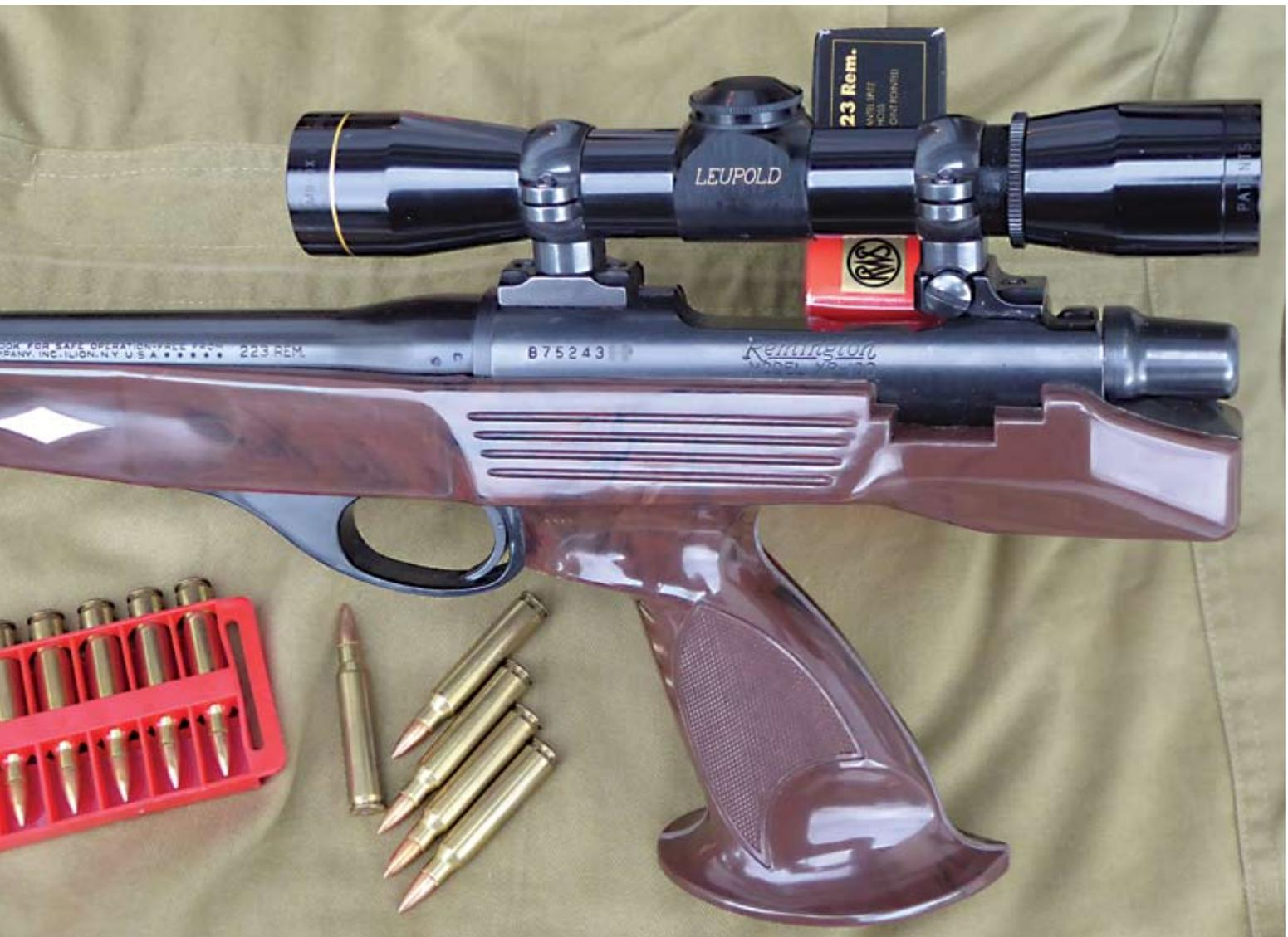
wenig, wie die Büchsen der Baureihe Rem. 600. Schließlich findet man, gut verborgen, links zwischen Hülsenbrücke und Verschuß den Schloßhalter, den man allerdings mit einem dünnen Schraubendreher oder einem ähnlich zarten Instrument niederdrücken muß und dabei den Verschuß herausziehen kann (siehe Abb.).
