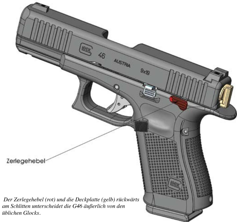
*Der Zerlegehebel (rot) und die Deckplatte (gelb) rückwärts am Schlitten unterscheidet die G46 äußerlich von den üblichen Glocks.*
