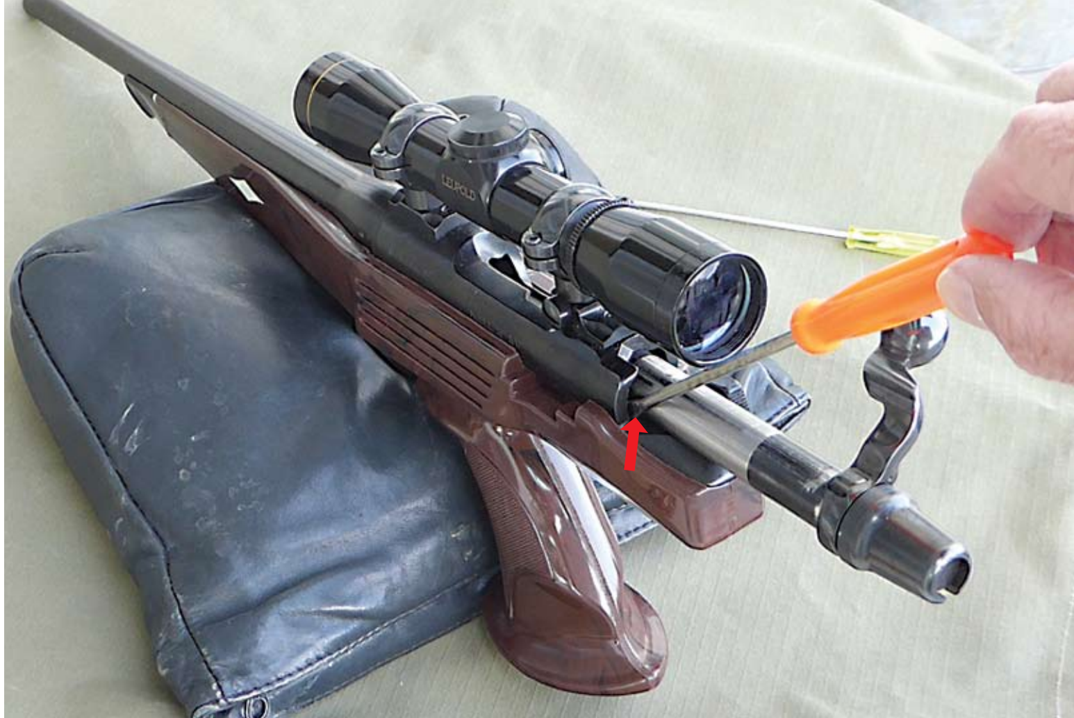
Zum Entfernen des Verschlusses muss der Verschlusshalter auf diese Weise niedergedrückt werden.
