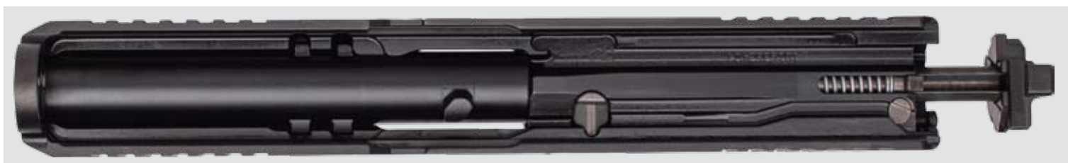
Blick in den abgenommenen Schlitten. Deutlich sind die vier Verriegelungswarzen am Drehlauf zu erkennen sowie die rückwärts ausgetretene Deckplatte.
