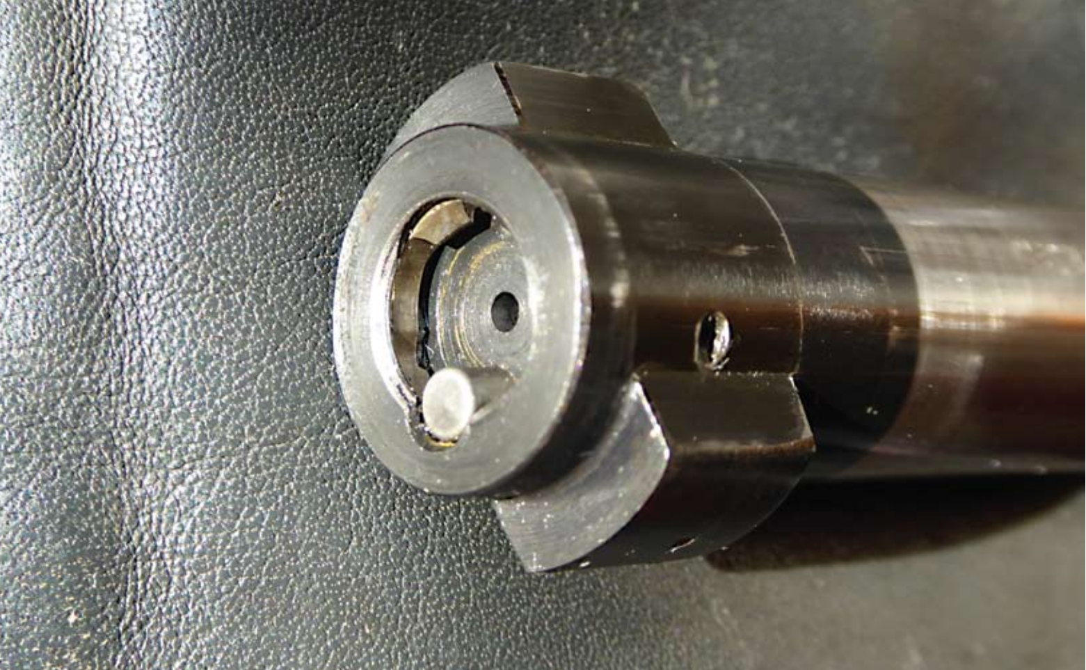
Verschlusskopf mit Ausstoßer und Auszieher und Entlastungsbohrung
