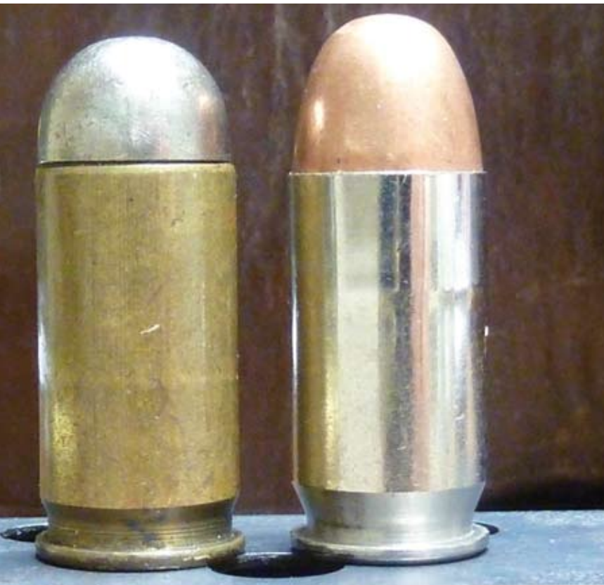
Von links: die Patrone Webley & Scott .455 Auto zum Vergleich: rechts die Colt .45 ACP. Letztere hat eine kürzere Hülse aber eine größere Gesamtlänge.
