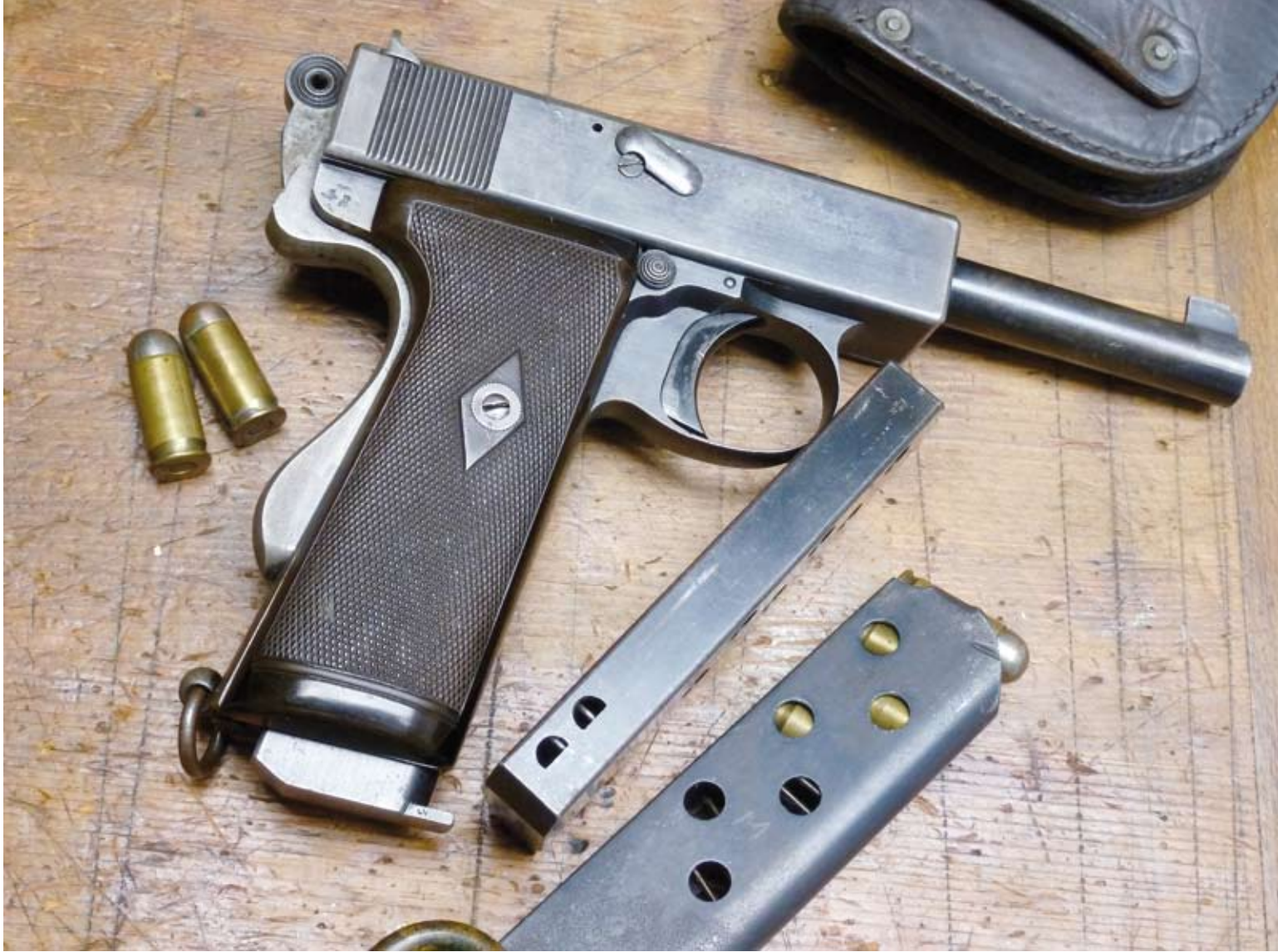
Zivile W&S .455 Auto von rechts. Das Magazin in 2. Rast, bei den abgebildeten Magazinen deutlich die großen Sichtfenster und die 2 Kerben für die beiden Positionen. Oben: Patronentasche mit Nieten.
