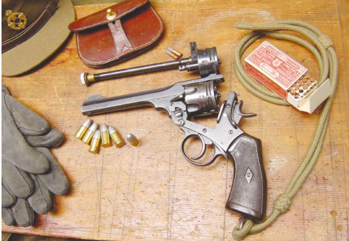
Zum Vergleich: Webley Mark VI mit wiedergeladenen .455 Patronen. Darüber Hale.22 Adapter mit .22 lr Patronen
