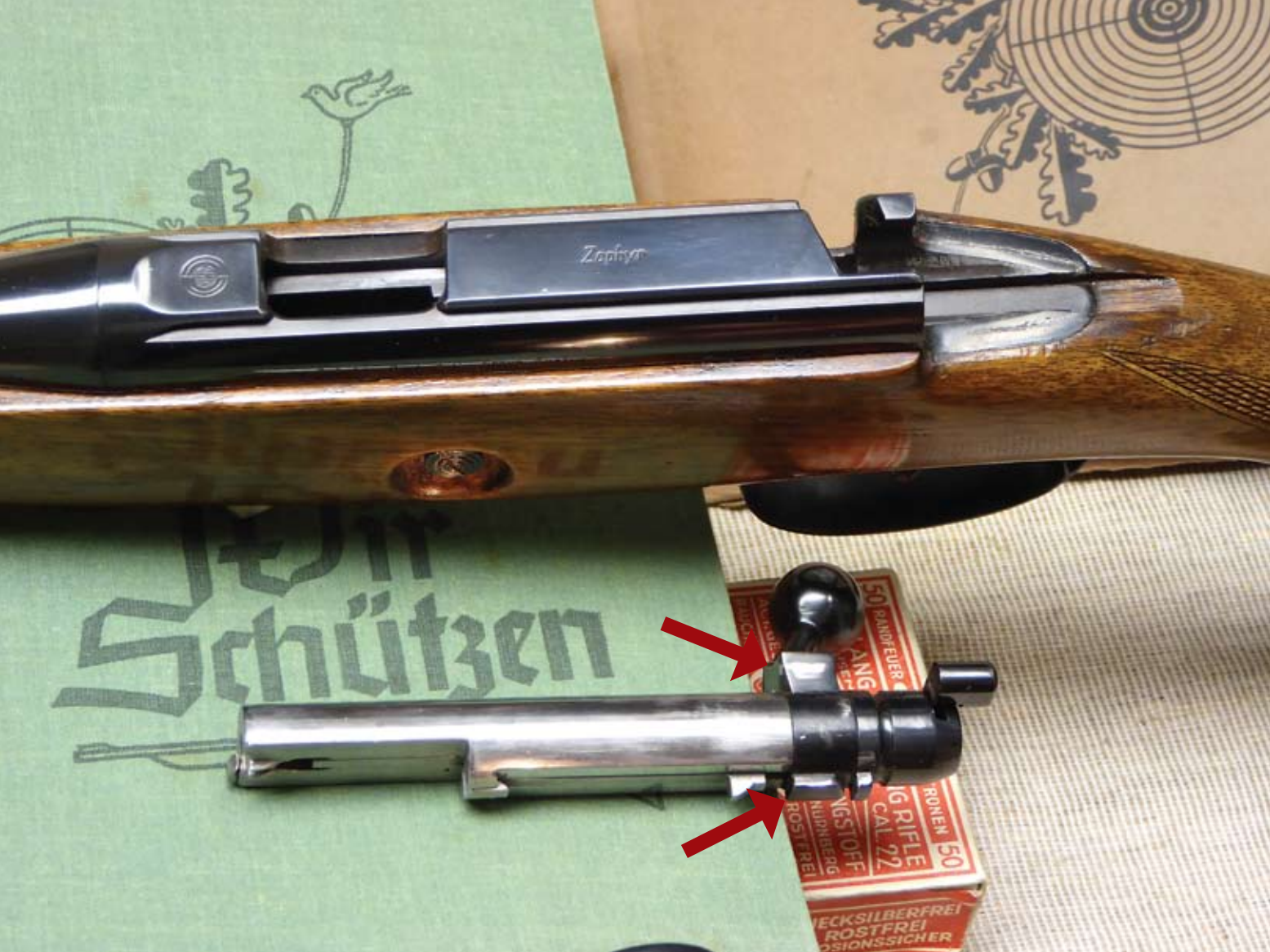
altes Modell zum Reinigen zerlegt, deutlich zu sehen: Doppelte Verriegelung (siehe Pfeile) und Kratzspuren am System
