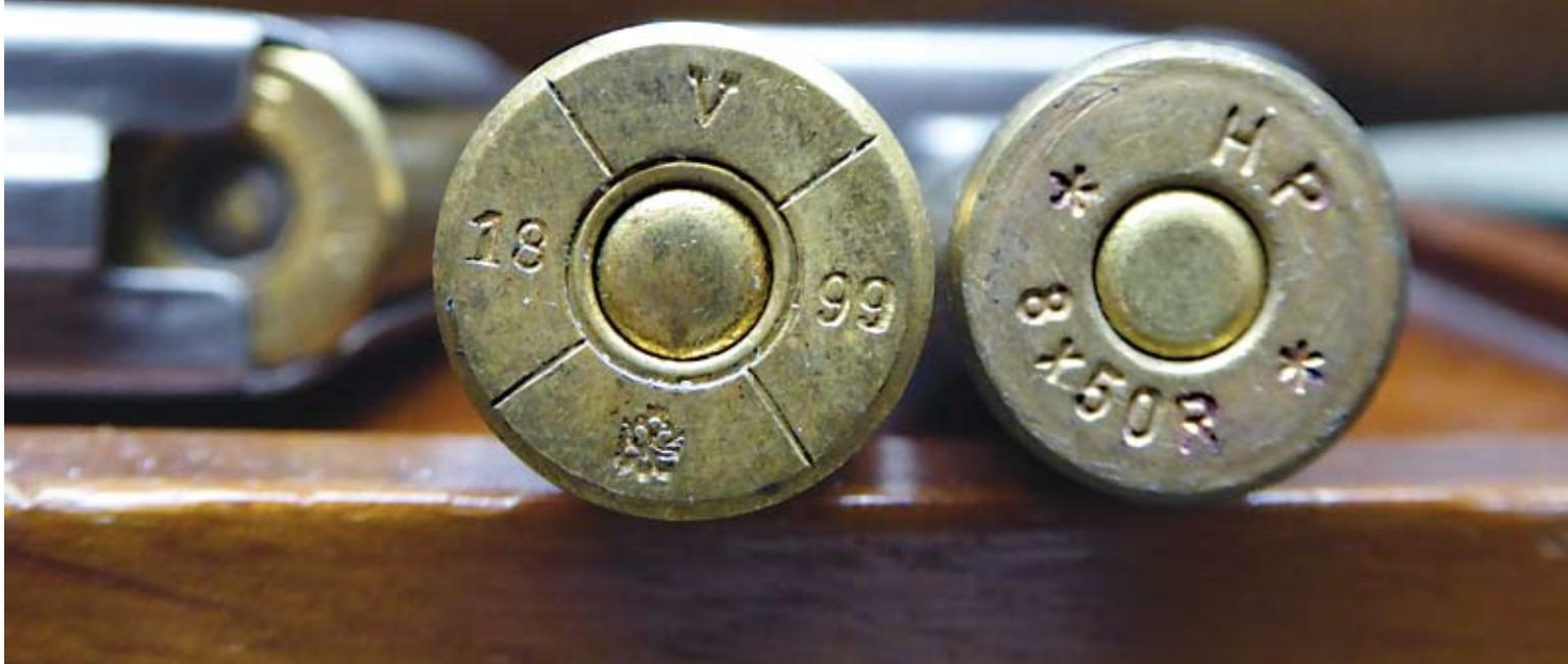
Links: 11 mm Maudry, der Bodenstempel der AZF des Wiener Arsenalts zeigt die Charakteristika militärischer Versuchspatronen. Rechts: aus 8 x 50 R HP-Hülse umgeformte „neue 11 mm Maudry-Patrone“. Patronenbodenmaße sind gleich
