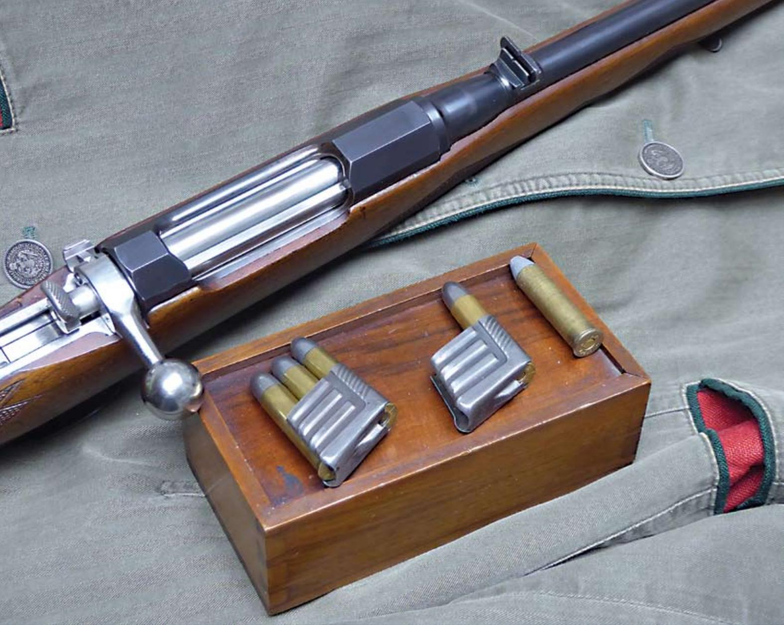
*M.95 System Mannlicher für Kaliber 11mm Maudry (11 x 45,5) mit Originalpatronen in den gekürzten Ladestreifen. (Paketladungen) Rechte Patrone aus Hülse HP 8 x 50 R aufgeweitet auf 11mm.*
