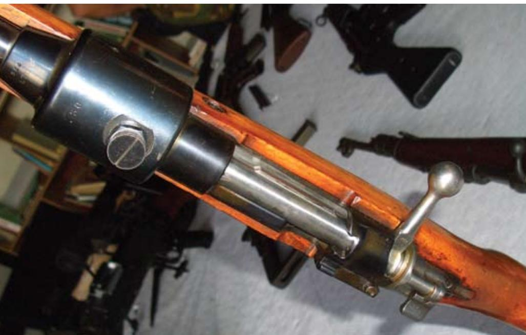
Gasdruckmessenrichtung auf einem Karabiner 98 belgischer Fertigung
