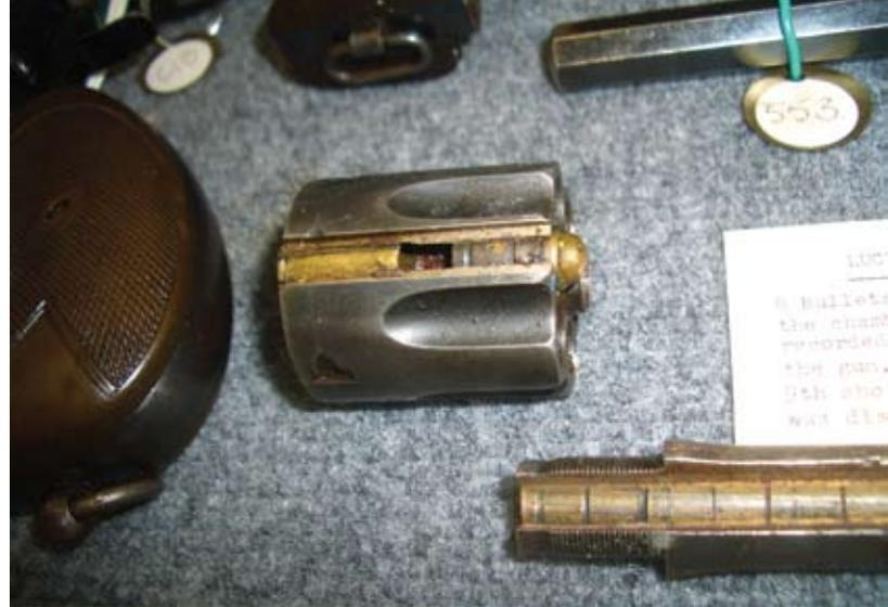
Ein Extremfall: 8 Geschosse im Lauf- natürlich kein Treffer. Der 9. Schuß blieb zwischen Trommel und Lauf stecken und blockierte die Trommel.
