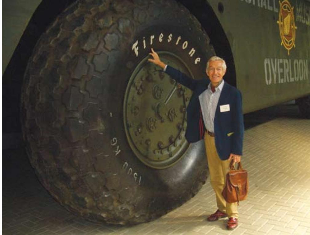
*Das größte Amphibienfahrzeug der Welt: je ein V8 Motor treibt ein Rad an, zwei Motoren die beiden Schiffschrauben.*
