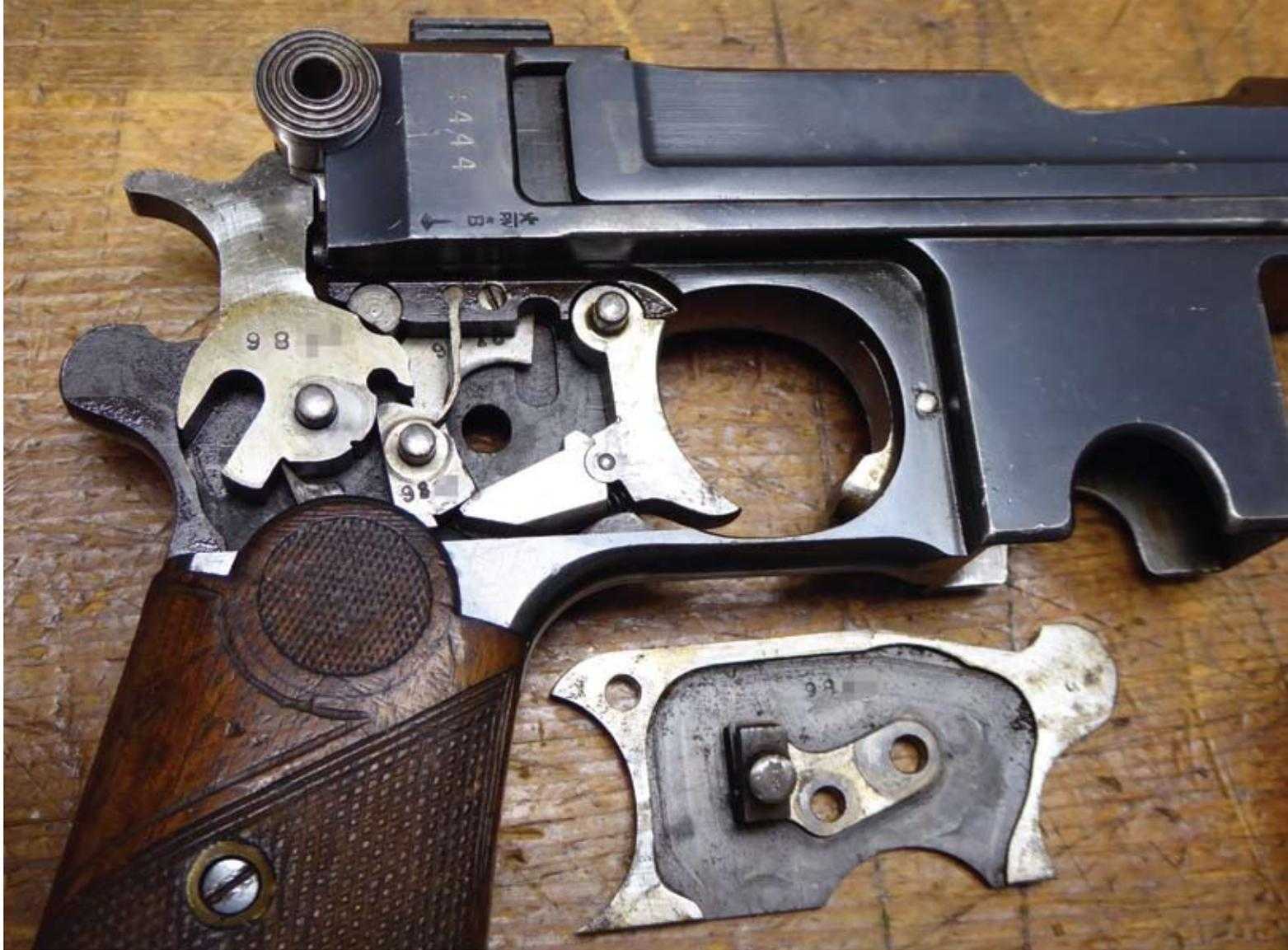
Zum Reinigen zerlegt, Deckplatte abgenommen
