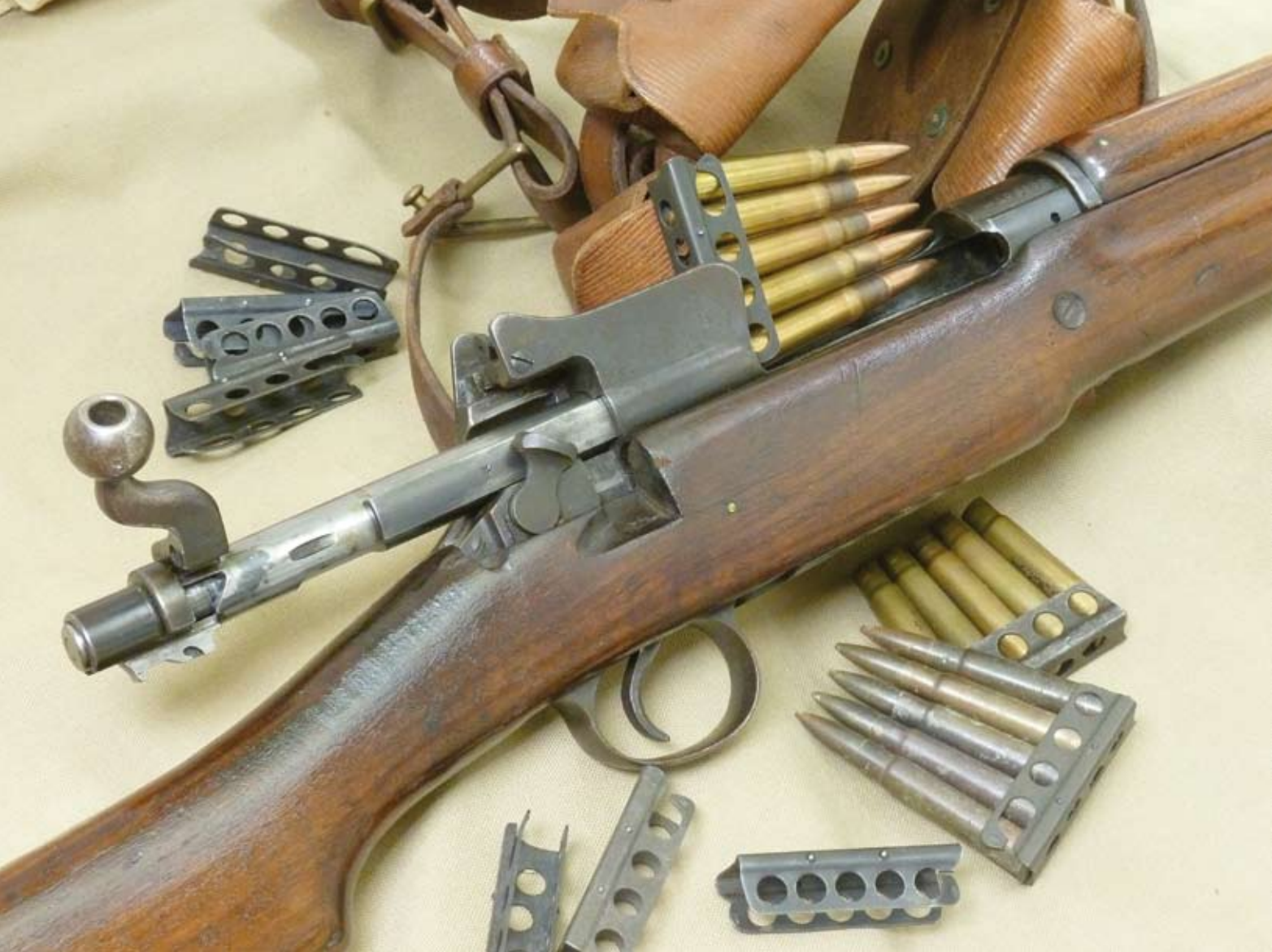
P 14 Verschuß geöffnet mit angesetztem Ladestreifen
