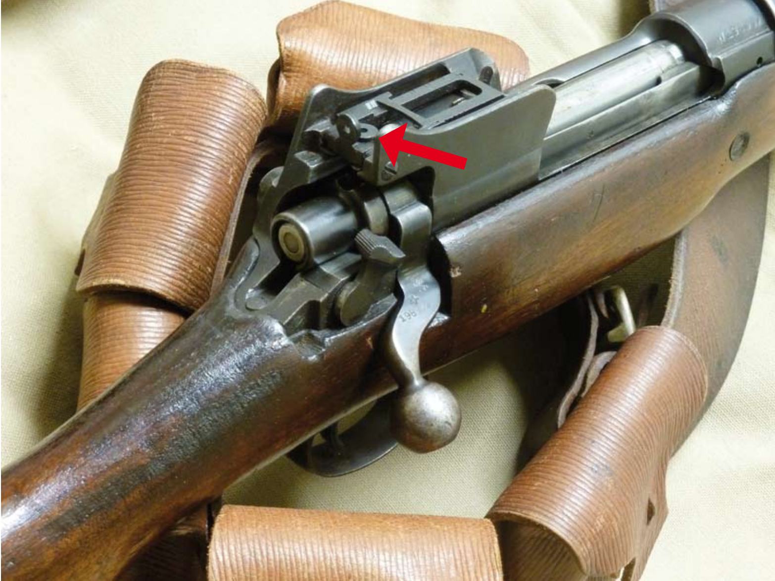
P 14 aus Winchester Fertigung (W mit Seriennummer), deutlich sichtbar der gekrümmte Kammerstengel und das Dioptervisier
