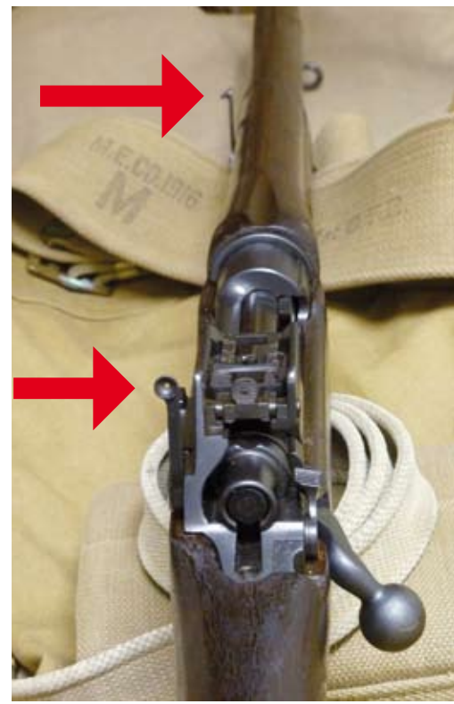
P 14 Remington (RE) mit aufgeklapptem „Long range sight“ auf der linken Seite. Die Entfernungsskala ist vorne links beim Korn.
