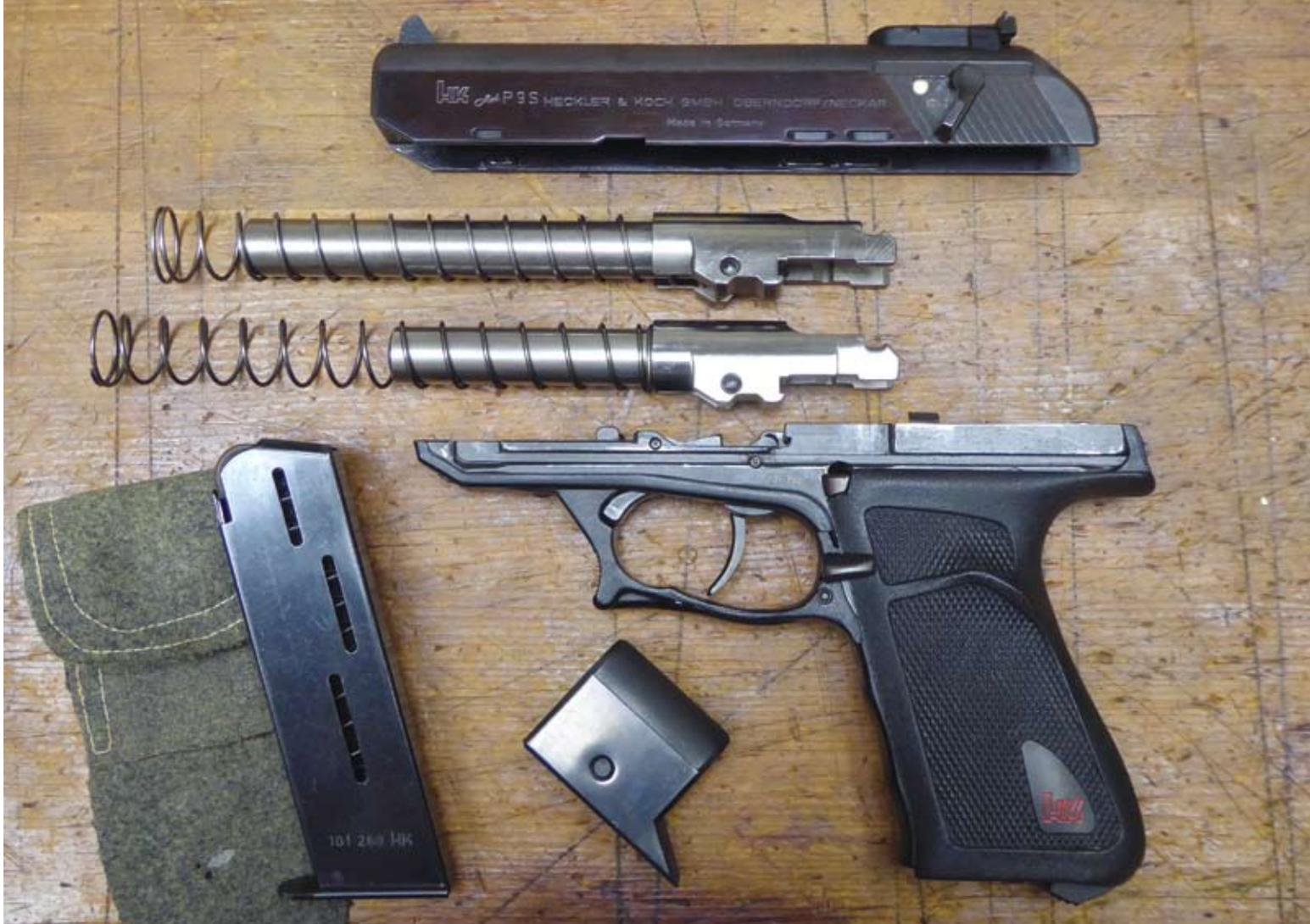
*Pistole zum Reinigen und Umrüsten auf den 140mm Lauf mit Laufgewicht, bereitgelegt*
