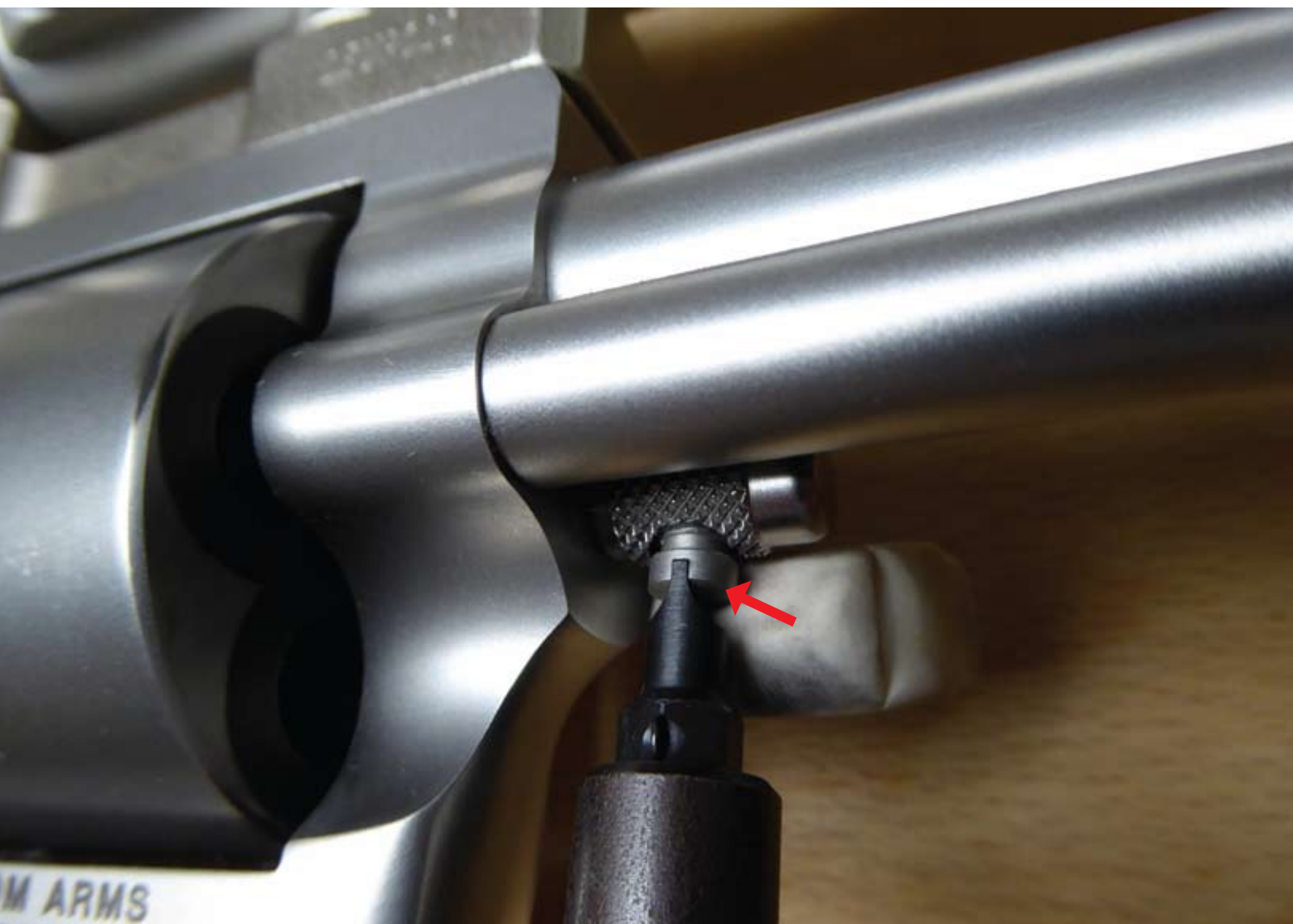
So exakt hat ein Schraubendreher in den Schlitz zu passen (Pfeil)
