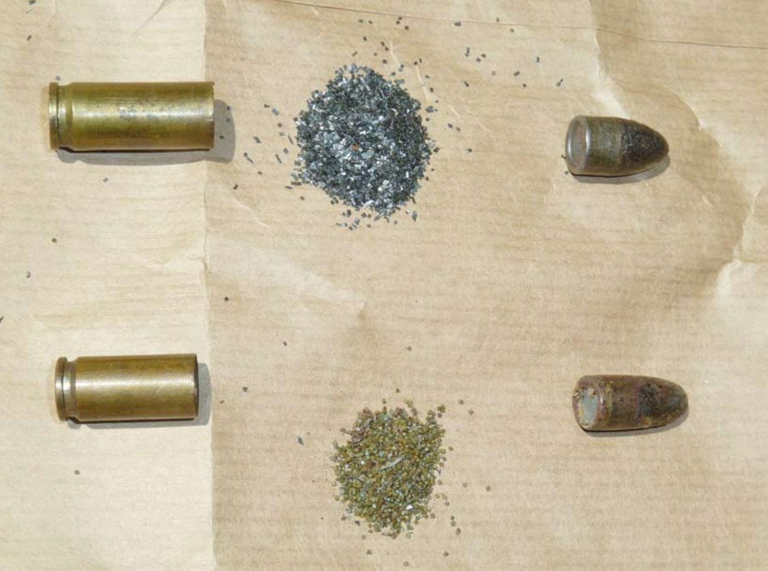
*9mm Steyr (oben), 8mm Roth/Krnka (unten), Geschossgewicht (7,5 g) bei beiden gleich*
