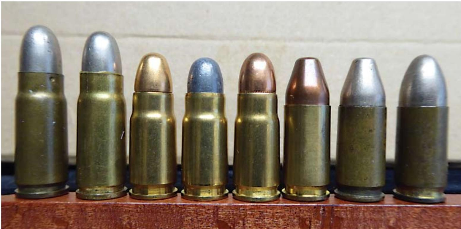
Von links: 7,63 DWM 403, 7,63 Mannlicher, 7,65 Parabellum: Geco VM, Geco Bleigeschoß, 7,65 Parabellum Fiocchi VM, 9mm Parabellum, 9mm Glisenti, 9mm Parabellum DWM 480 C.
