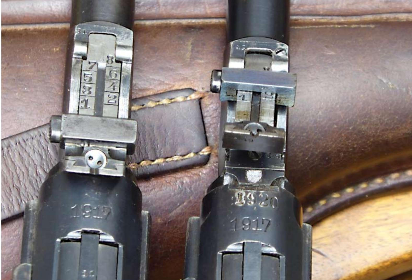
*Lange Pistole 08, Fertigung DWM 1917, rechts mit Doppeldatum, links Visier mit Feineinstellung, Distanz 50 m, rechts Distanz 800m, deutliche Abweichung des Visiers nach links. (siehe Text)*
