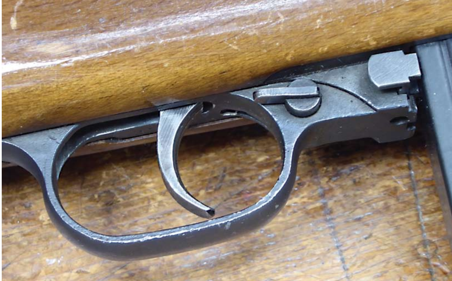
Detail: Sicherung, Magazinhalterung und original KM 1 Magazin.
