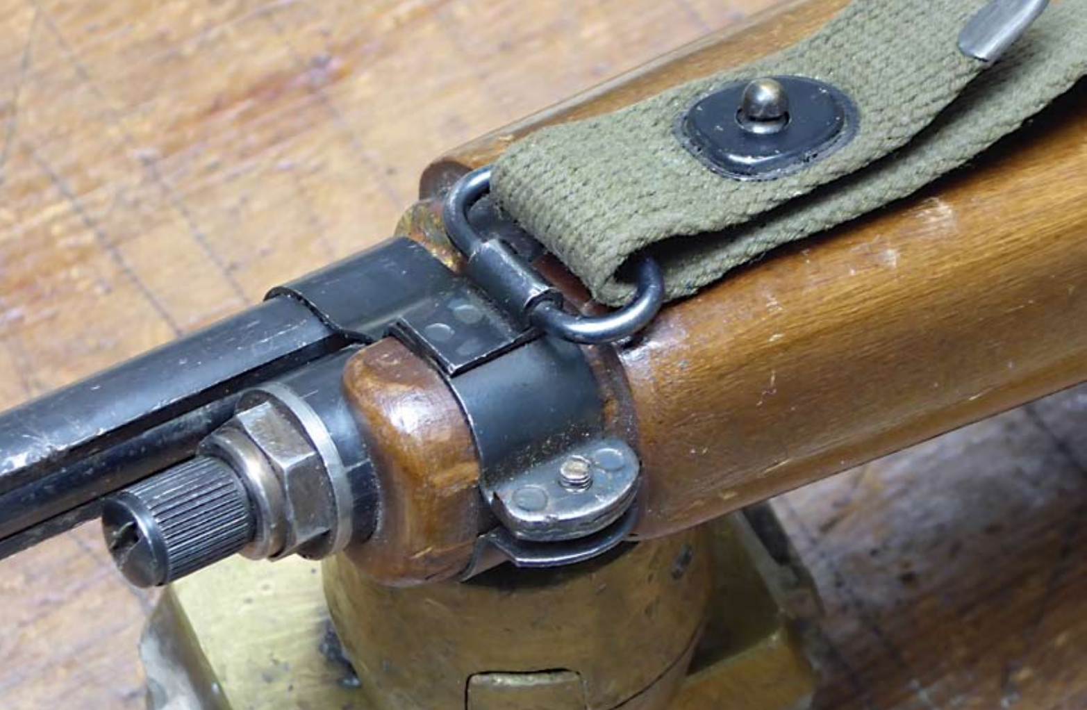
Füllventil mit Verschlussschraube und vorderer Riemenbügel
