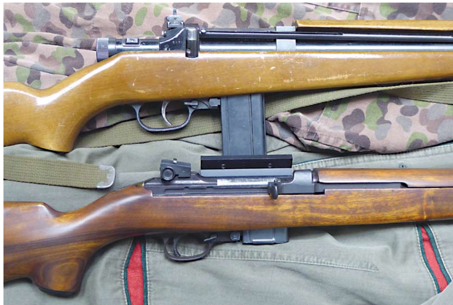
Oben: Üb KM 1 mit original 15 Schußmagazin Unten: jagdlich geschäftetes KM 1 mit ZF Vorbereitung im Originalkaliber 7,62mm mit 5 Schußmagazin
