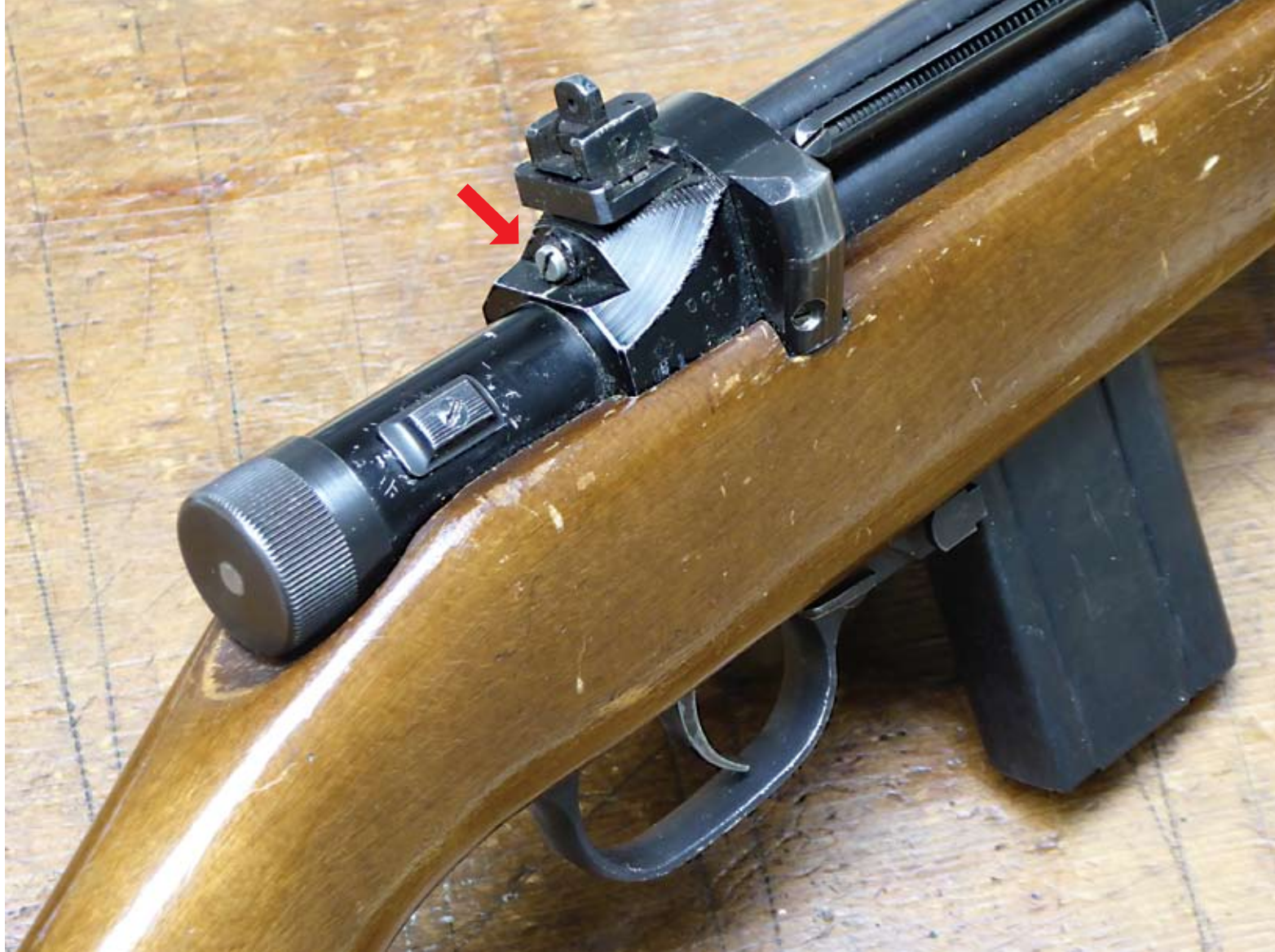
Üb KM 1 von rechts hinten, Visier und Schaulochschraube. Nach Entfernung dieser Schraube kann der Lauf visitiert werden.
