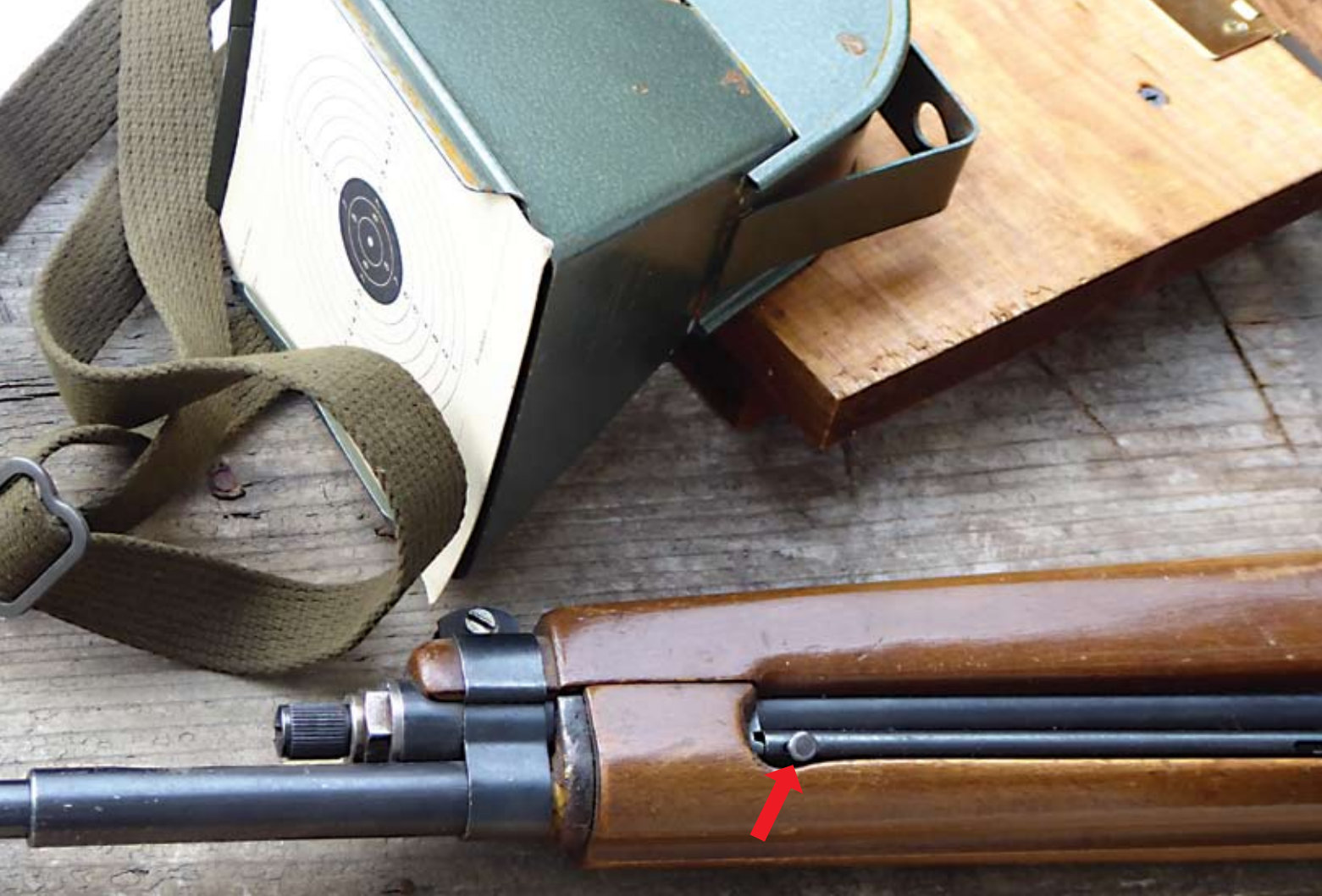
Üb KM 1 von rechts, deutlich sichtbar das vordere Ende des Rohrmagazins mit dem Entriegelungsknöpfchen und das Füllventil mit Verschußschraube.
