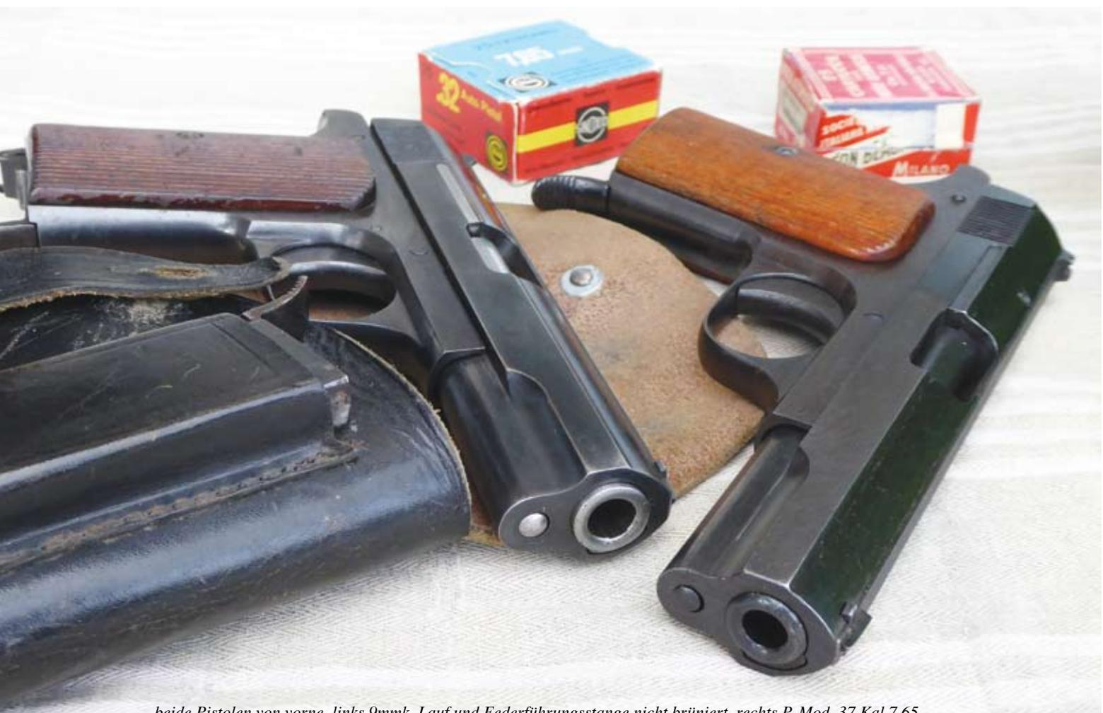
beide Pistolen von vorne, links 9mmk, Lauf und Federführungsstange nicht brüniert, rechts P. Mod. 37 Kal.7,65
