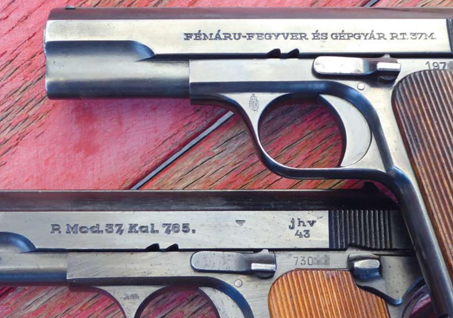
oben ungarische Armeepistole 37 M in Kal. 9mmk, darunter das deutsche Mod 37, Kal.7,65. Code jhv 43, am Abzugsbügel die undeutliche Wehrmachtsabnahme, WaA 173.
