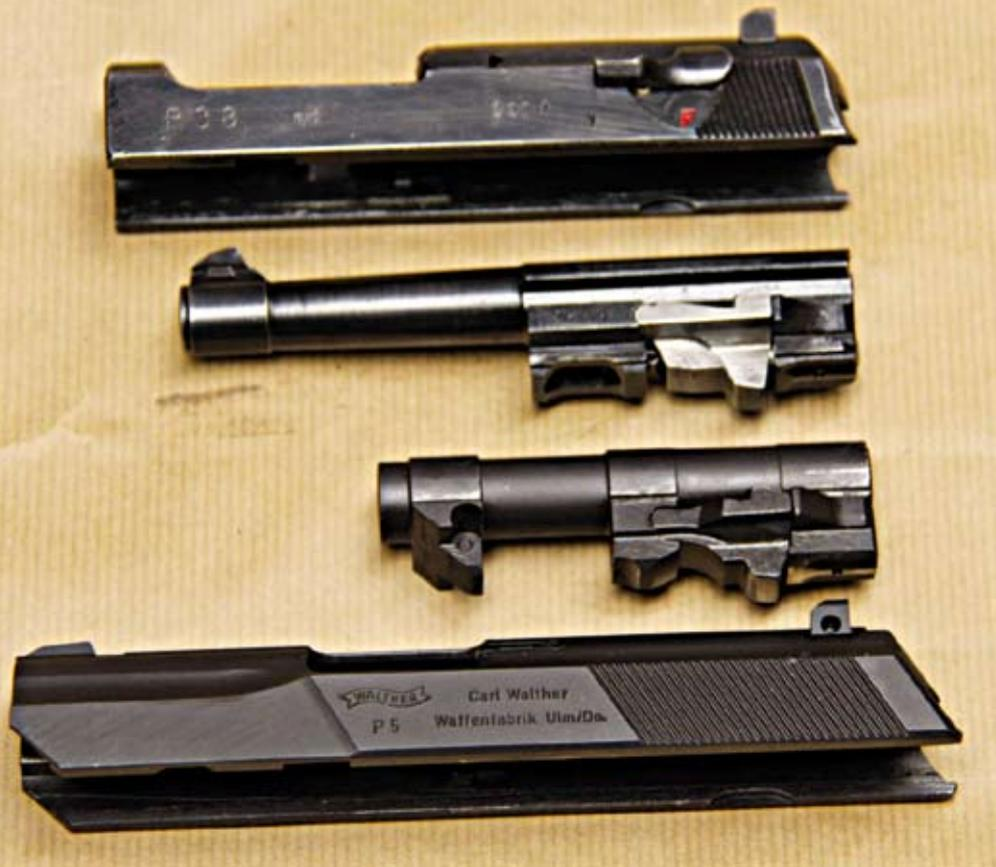
Oben P.38 Verschluß und Lauf. Zum Vergleich: Lauf und Verschluß P5, bitte Schwenkriegel beachten
