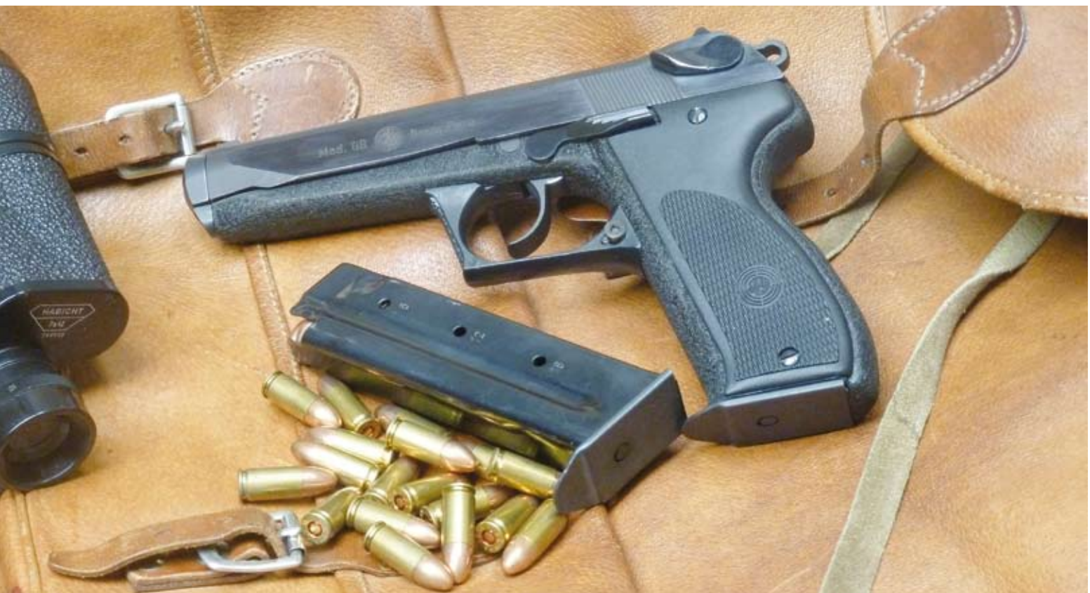
Steyr GB mit Ringhahn und Reservemagazin. Eine Magazinfüllung von 18 Patronen liegen bereit
