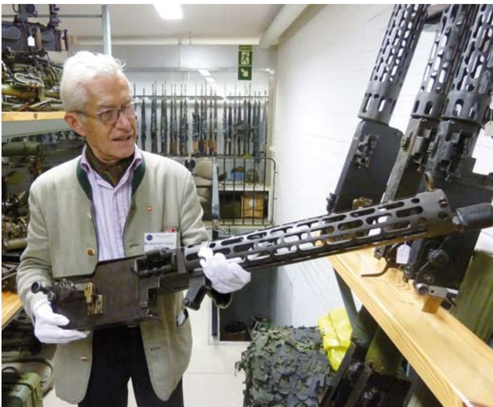
In einer finnischen Privatsammlung: Dr. Gerig hält ein luftgekühltes L.M.G. 08/15. Gwf. SPANDAU 1917. Diese Type MG wurde in Zeppelinen und Flugzeugen verwendet.
