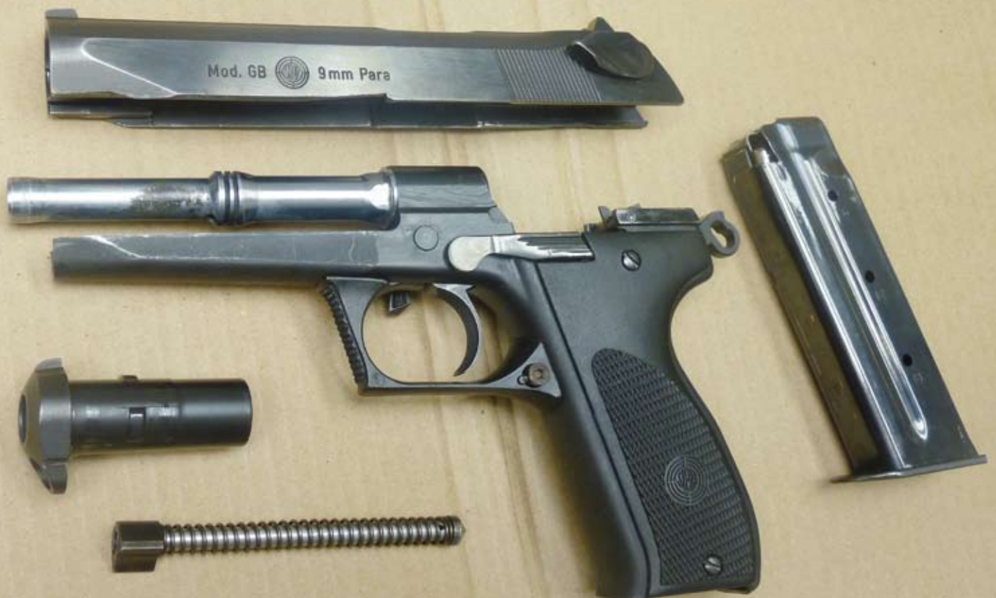
Steyr GB zur Reinigung zerlegt. Man beachte die Reste der starken Verschmauchung am Lauf und das brünierte Griffstück, also ohne Schrumpflack
