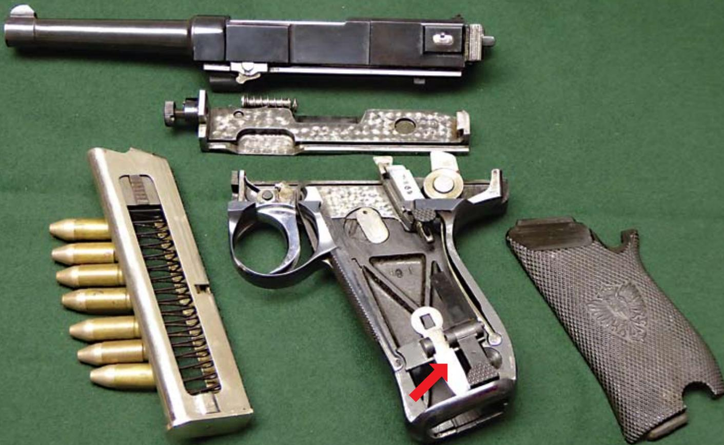
Zum Reinigen zerlegt. Sonnenschliff und Mehrzweckwerkzeug beachten (roter Pfeil). Magazin mit 7 Originalpatronen. 8 gehen ins Magazin, nur dann rastet das Magazin nicht ein!!
