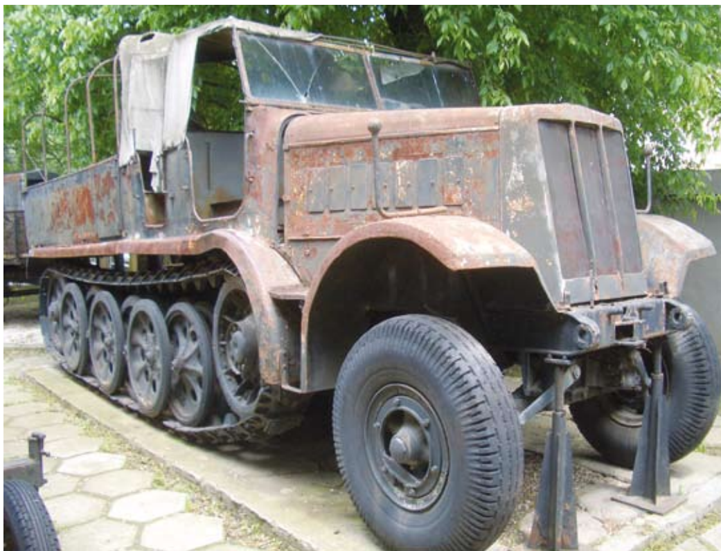
Halbkettenzugmaschine für 18 Tonnen Anhängelast im Panzergarten des Armeemuseums in Bukarest. Die Zugmaschine s.Zgkw. 18 to (Sd. Kfz.9) war das größte Modell dieser Art bei der Wehrmacht, leistete 250 PS, erreichte eine Höchstgeschwindigkeit von 50 Km/h und verbrauchte im Gelände auf 100 km 270 Liter Benzin. Einen Panzer III abzuschleppen war für die 18 to Zugmaschine kein Problem, für einen Tiger oder Panther brauchte man jedoch mindestens 2 dieser Fahrzeuge. Leider sind alle Fahrzeuge im Freien aufgestellt und nicht restauriert.
