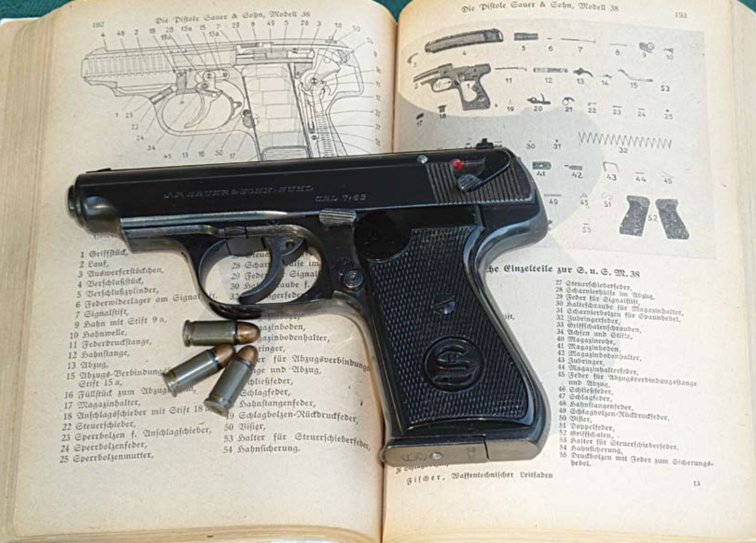
Sauer & Sohn Mod.38 dabei 3 Patronen mit Eisenhülsen. Magazinunterseite zeigt zwei verschlungene S und die Kaliberangabe Cal. 7,65
