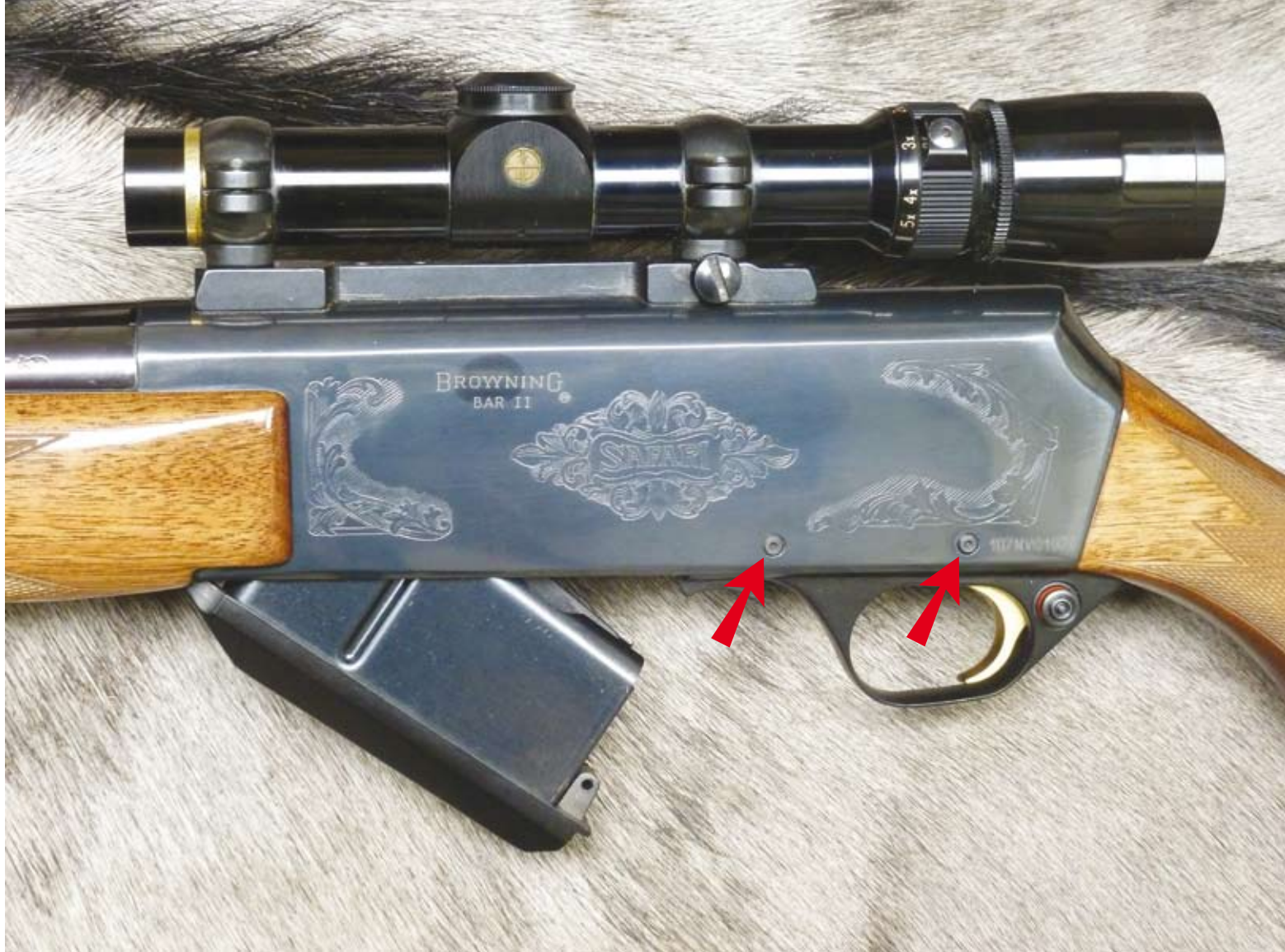
BAR -II von links, Magazin mit Halterung herausgeklappt. Zur Entfernung der Abzugseinheit beide Bolzen durchdrücken (Pfeile)
