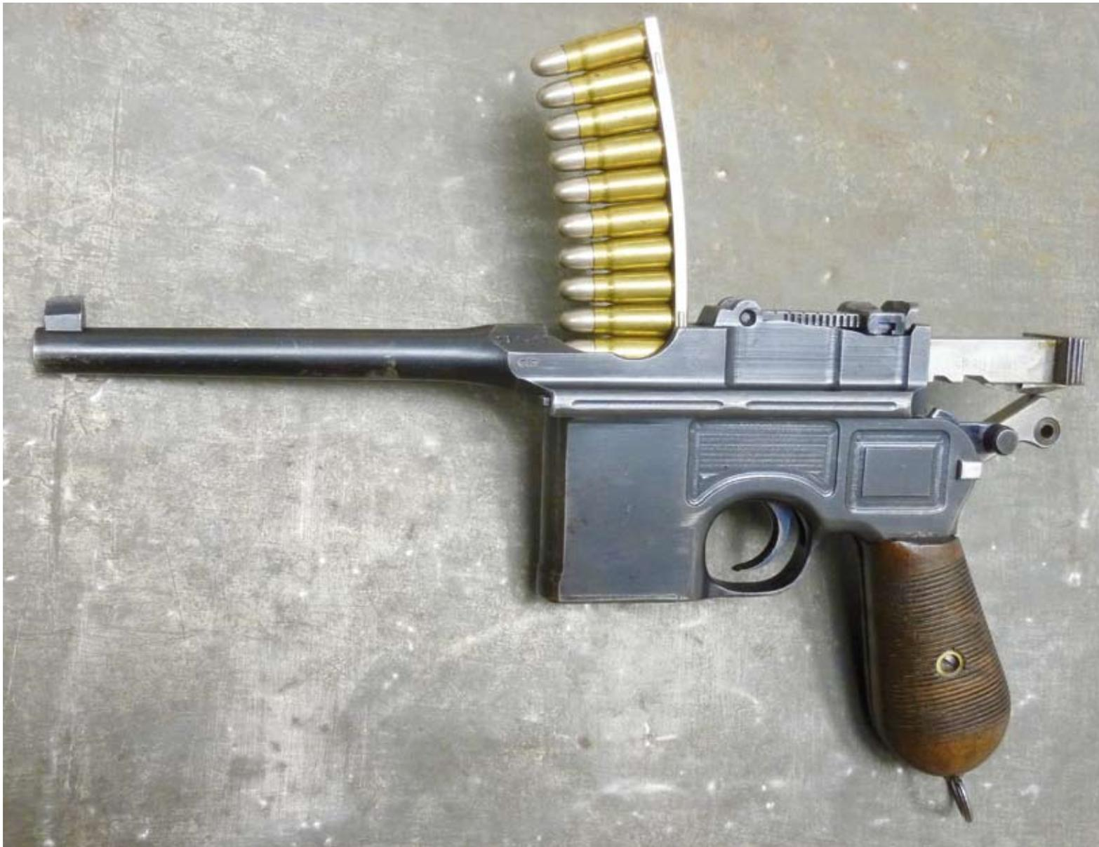
*Mauser C 96 mit aufgesetztem Ladestreifen. Nach Hinunterdrücken der Patronensäule Ladestreifen abziehen, der Verschluss schnell vor, die Pistole ist schußbereit.*
