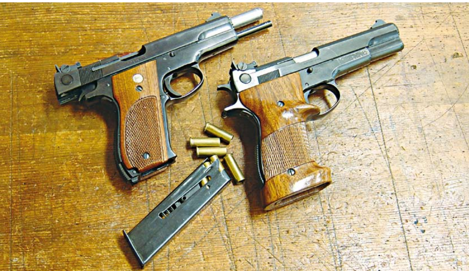
Model S&W No. 52-2 mit kurzem Auszieher und rechts davon Model S&W No. 52-1 mit langem Auszieher und Matchgriff
