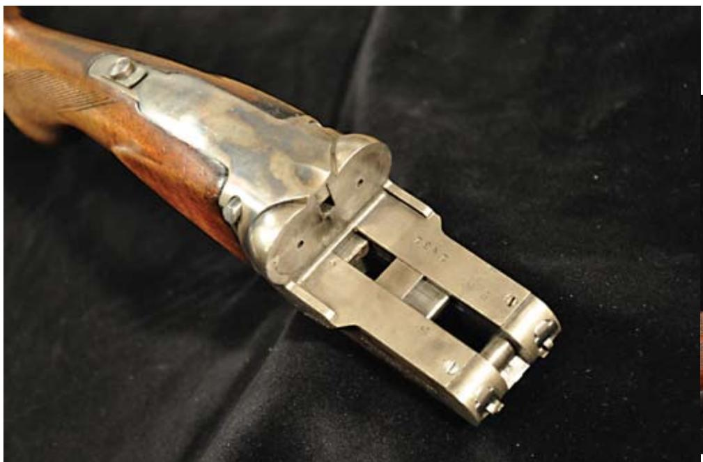
Sicht auf die Basküle, Blick auf die Ausnehmungen für die Laufhaken und für die Purdey-Nase, die Verstärkungsleisten sowie (hinter der rechten Muschel) auf den Drücker zum Ausschalten der automatischen Sicherung (geriffelter Kopf). (Abb. 7)
