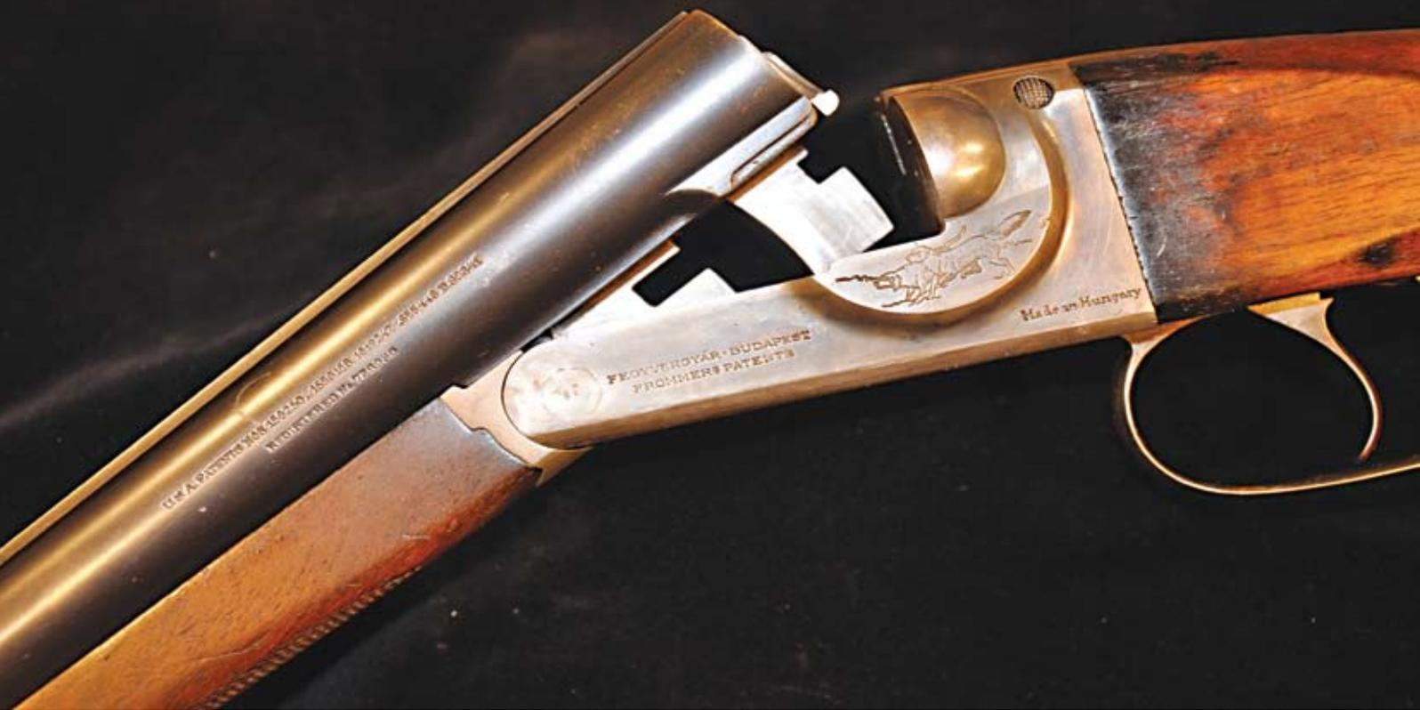
Ansicht der Flinte, Verschluss geöffnet, am linken Lauf sind die Patentnummern eingeschlagen (Abb. 6)
