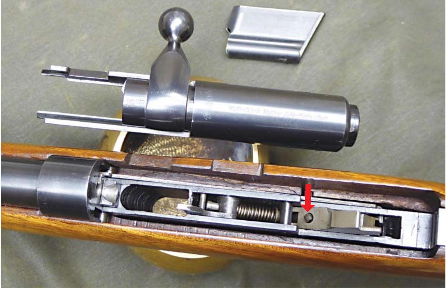
Zerlegt zum einfachen Reinigen. Pfeil zeigt auf Verstellemschraube am Hahn (siehe Text auf S. 25)
