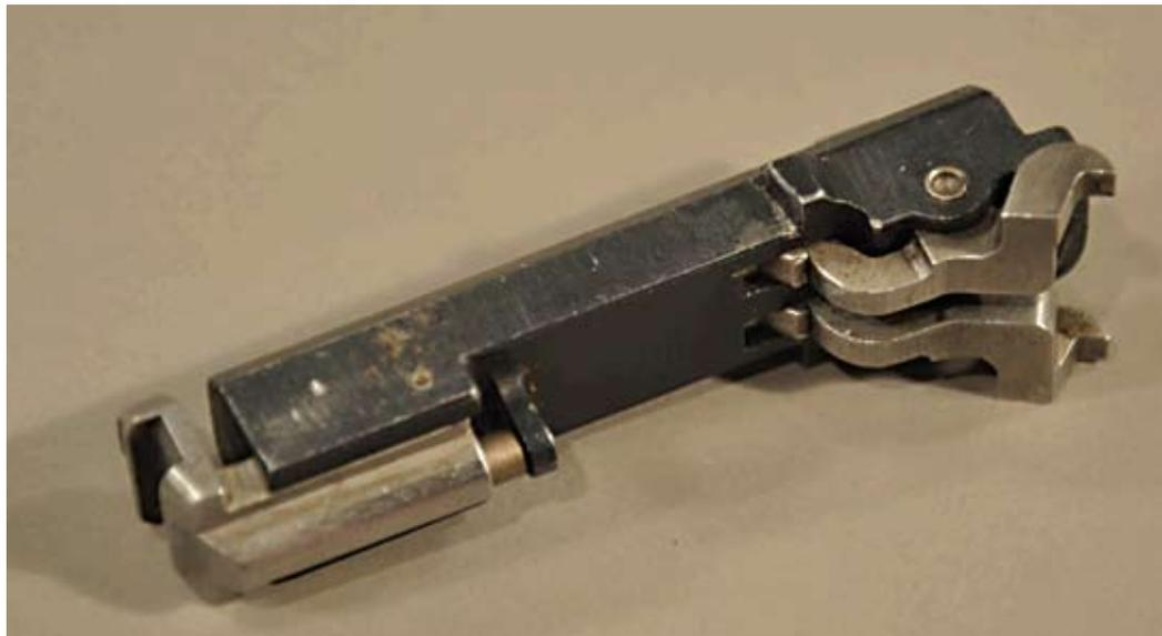
*Ejektoreinheit; links der Arretierungsdrücker (blank belassen), rechts sind die beiden Auslösehebel (blank) zu erkennen, mit denen die im brünierten Gehäuse gelagerten Ejektorfedern in gespannter Stellung gehalten werden (das Spannen der Ejektorfedern erfolgt durch die Schubstangen der Patronenzieher). (Abb. 5)*
