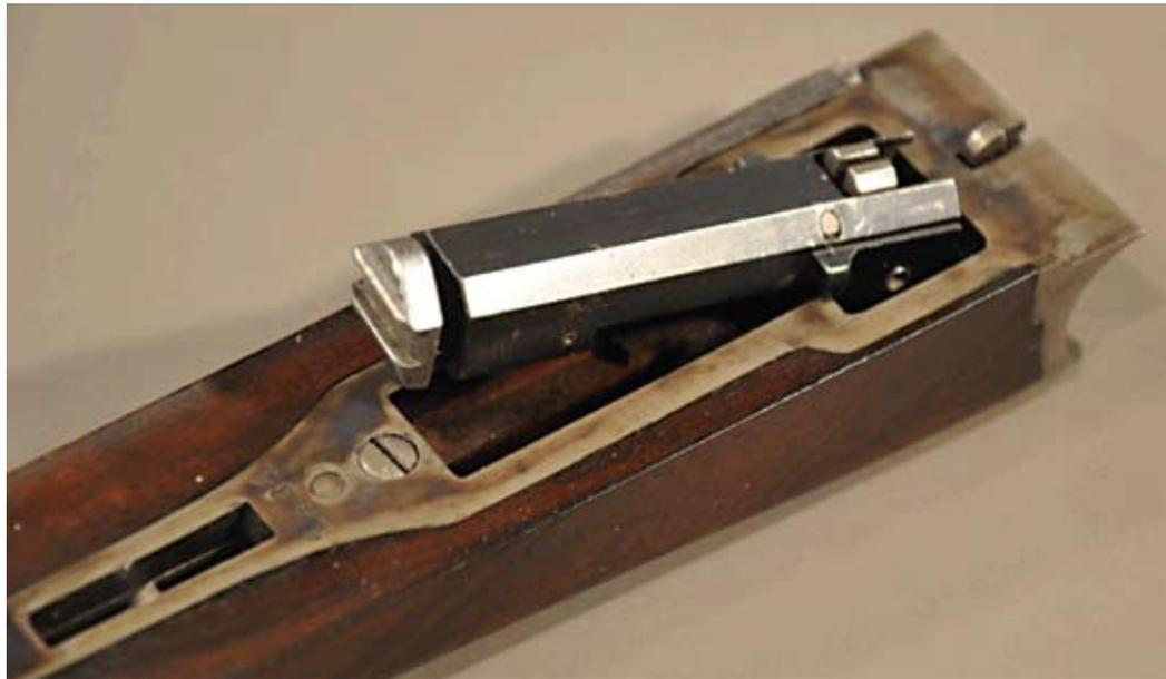
*Ejektoreinheit angehoben. Der blanke gerillte Teil am Vorderende der Ejektoreinheit dient der Fixierung in der Vorderschaftgarnitur. Die beiden (blanken) Nasen am Ende des Ejektors (rechts oben) betätigen die Schubstangen der Patronenzieher. Beim Schließen der Flinte werden dann über diese Nasen die Ejektorfedern wieder gespannt. (Abb. 4)*
