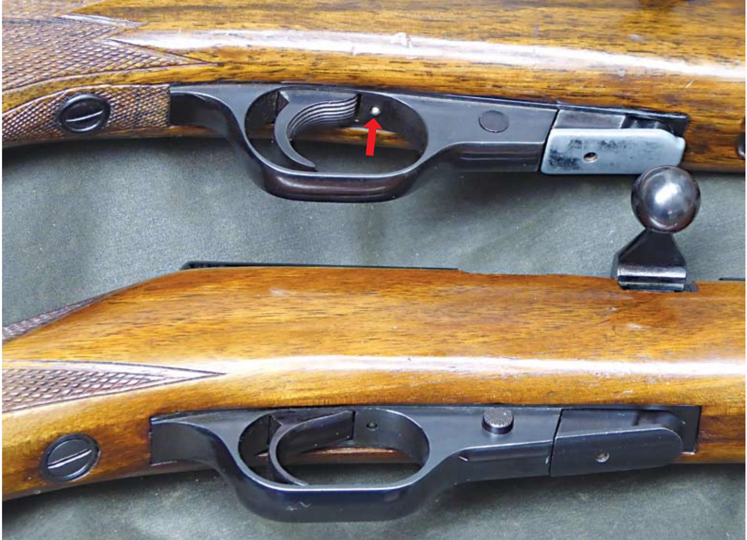
Oben Walther Mod. I mit hoher Seriennummer mit gerieftem Abzug und Magazinboden aus Zinkspritzguß. Vor dem Abzug zeigt der herausragende Signalstift entspanntes Schloß an (siehe Pfeil). Unten: gespannt, kein Signalstift sichtbar. Magazinboden aus Stahl, Abzug glatt. Ein weiterer Unterschied: der Magazinhalteknopf ist bei oberen Mod. I von links, am unteren von rechts zu bedienen.
