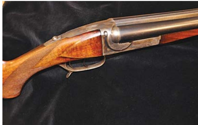
Ansicht von rechts; die glatte Scheibe und der Drücker zum Ausschalten der automatischen Sicherung (hinter der Muschel) sind zu sehen. (Abb. 10)
