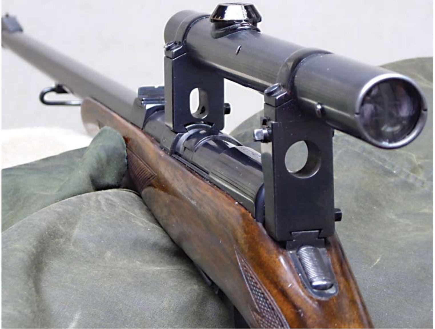
Hohe ZF Montage mit Durchsicht und nach rechts verlagert ZF Achse
