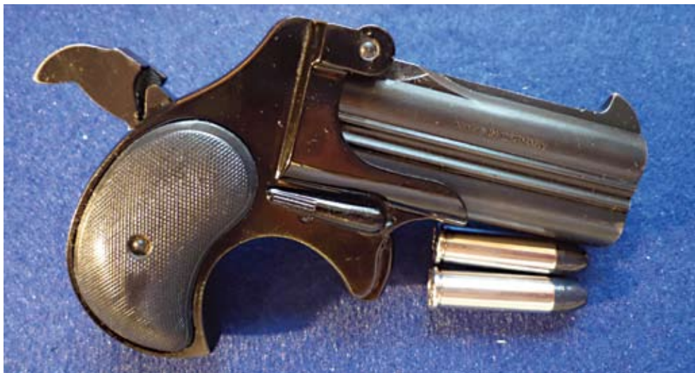
Die landläufig bekannten Derringer haben ein Bündel mit 2 Läufen und wurden bzw. werden nicht nur in den USA hergestellt: bekannt ist der Röhm-Derringer Mod. 17 im Kaliber .38 spl. Die Waffe ist im Feuer gut kontrollierbar, nur das Spannen des Hahns ist etwas gewöhnungsbedürftig.
