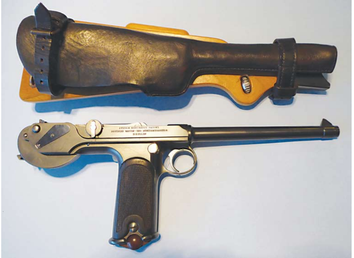
Der Pistolenkarabiner Borchardt C 93 mit Anschlagschaft. Fertigung: DEUTSCHE WAFFEN-UND -MUNITIONSFABRIKEN.BERLIN
