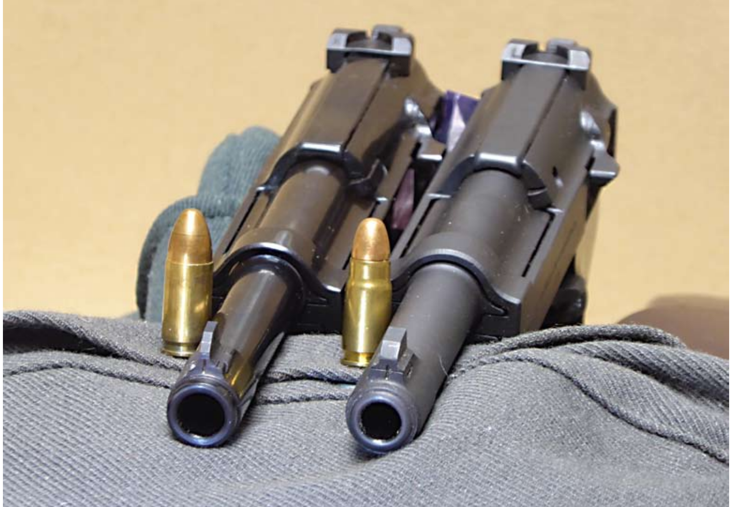
Zwei mal P 38 von vorne. Links 9 mm - rechts 7,65 Parabellum mit den dazugehörigen Patronen. Man beachte bei letzterer das breite Korn der Sportversion.
