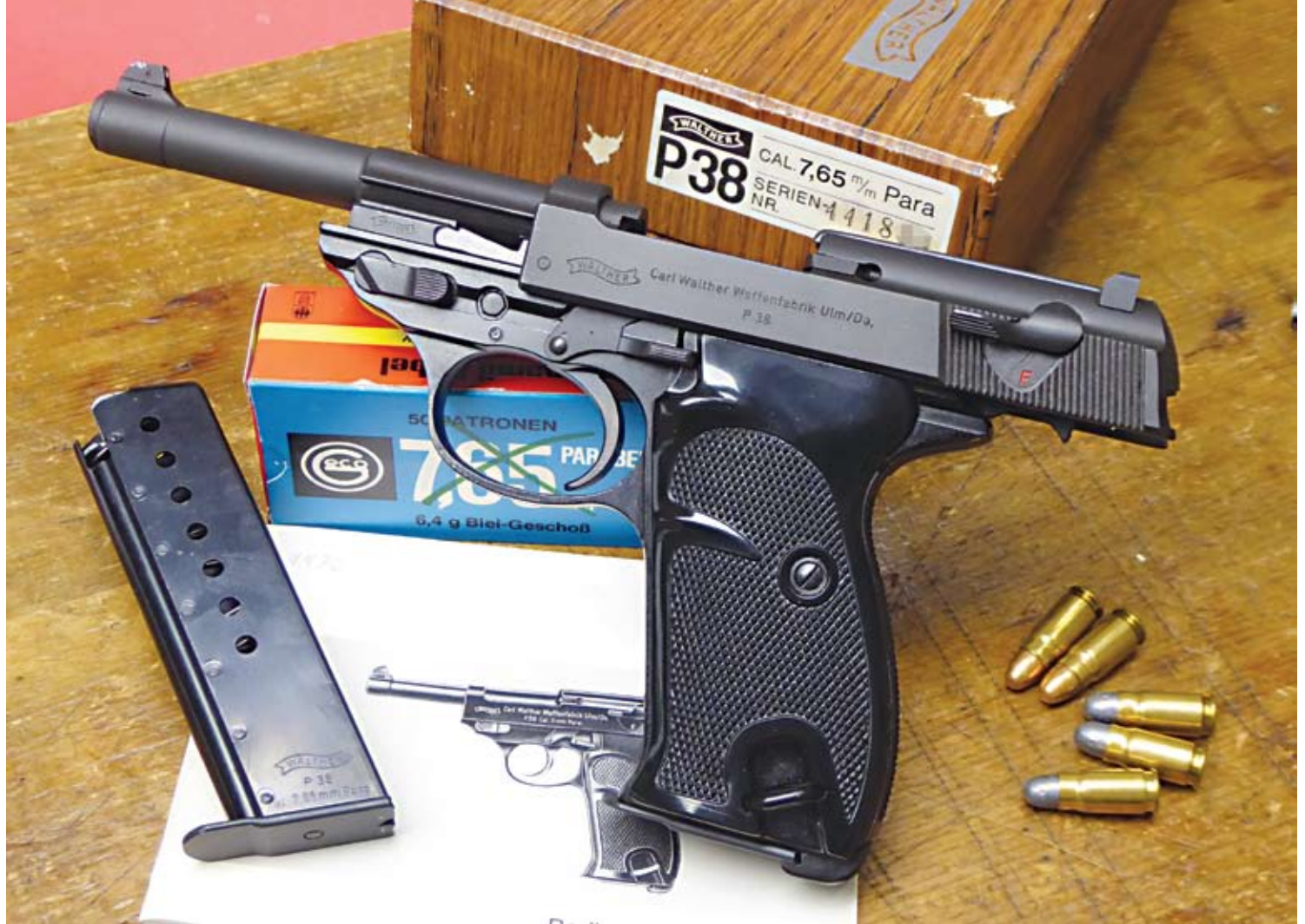
P 38 auf Patronenschachtel nach letztem Schuß offen. Man beachte auf Lauf und Schlitten die Walther Schleife und im Griffstück die hexagonale Verstärkung. Der Ring mit Punkt zeigt Ulmer Produktion an.
