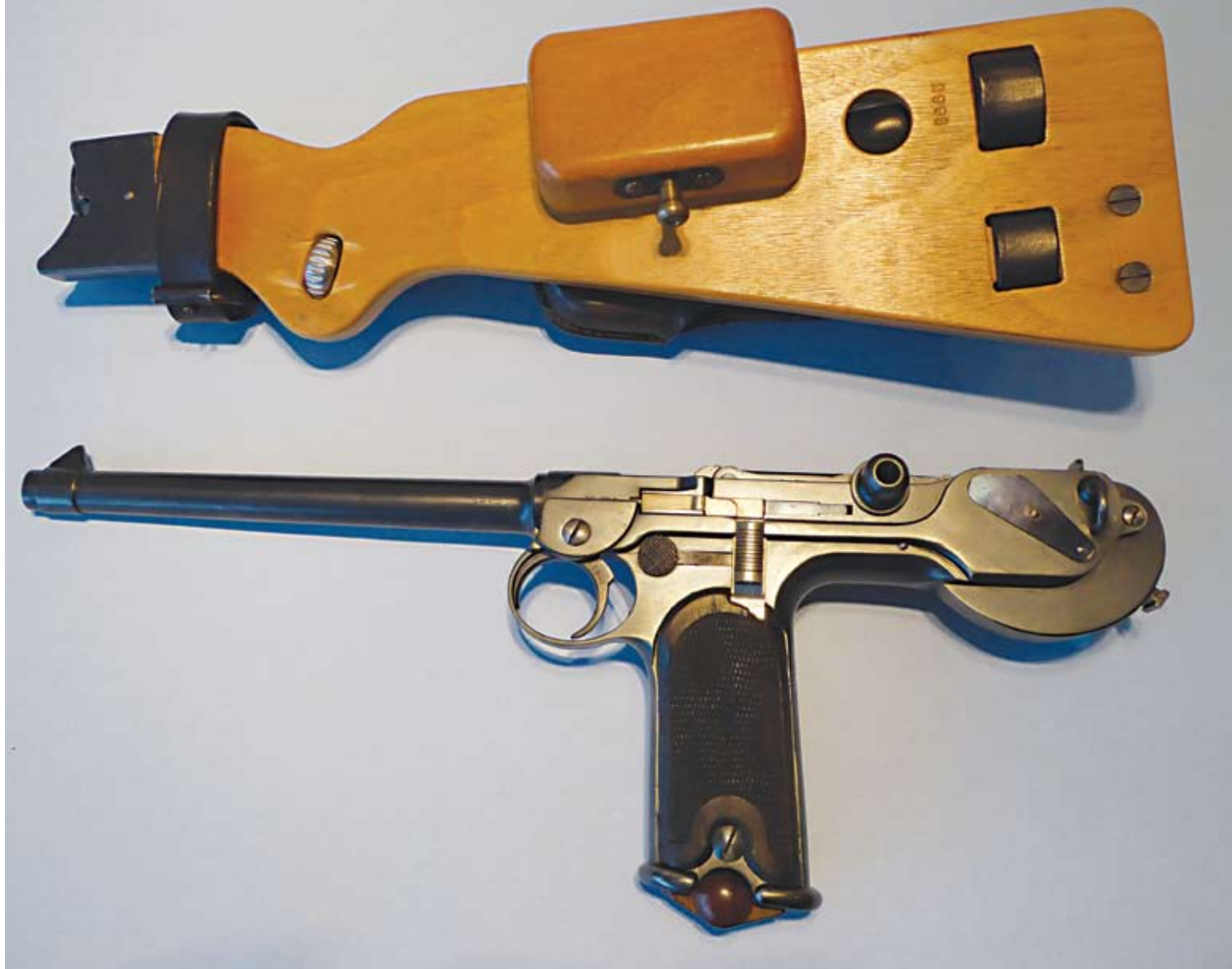
C93 mit Anschlagbrett und abnehmbarer Wangenauflage aus einer Schweizer Sammlung
