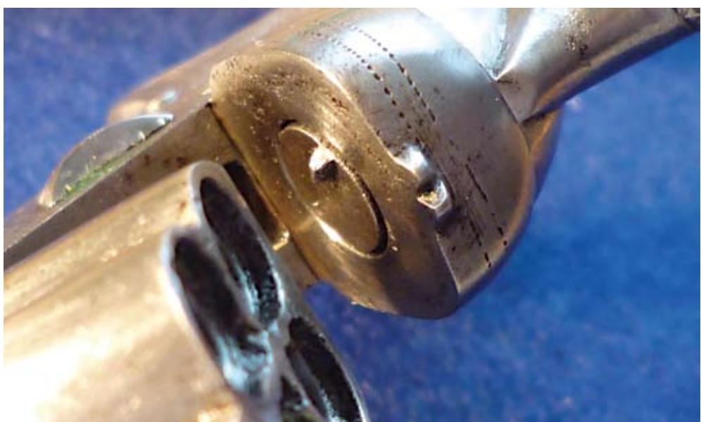
Verschuß geöffnet, mit Sicht auf das rotierende Schlagstück und die Zündnase. Das Schlagstück bildet einen Teil des Stoßbodens.
