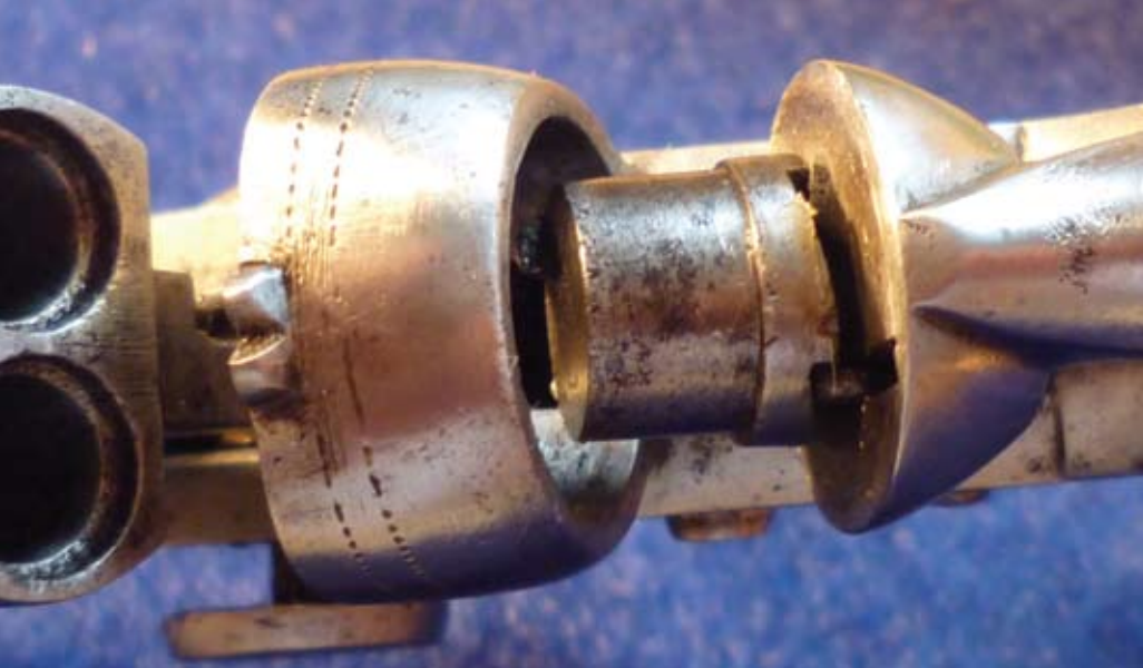
Verschuß geöffnet, mit Sicht auf das rotierende Schlagstück
