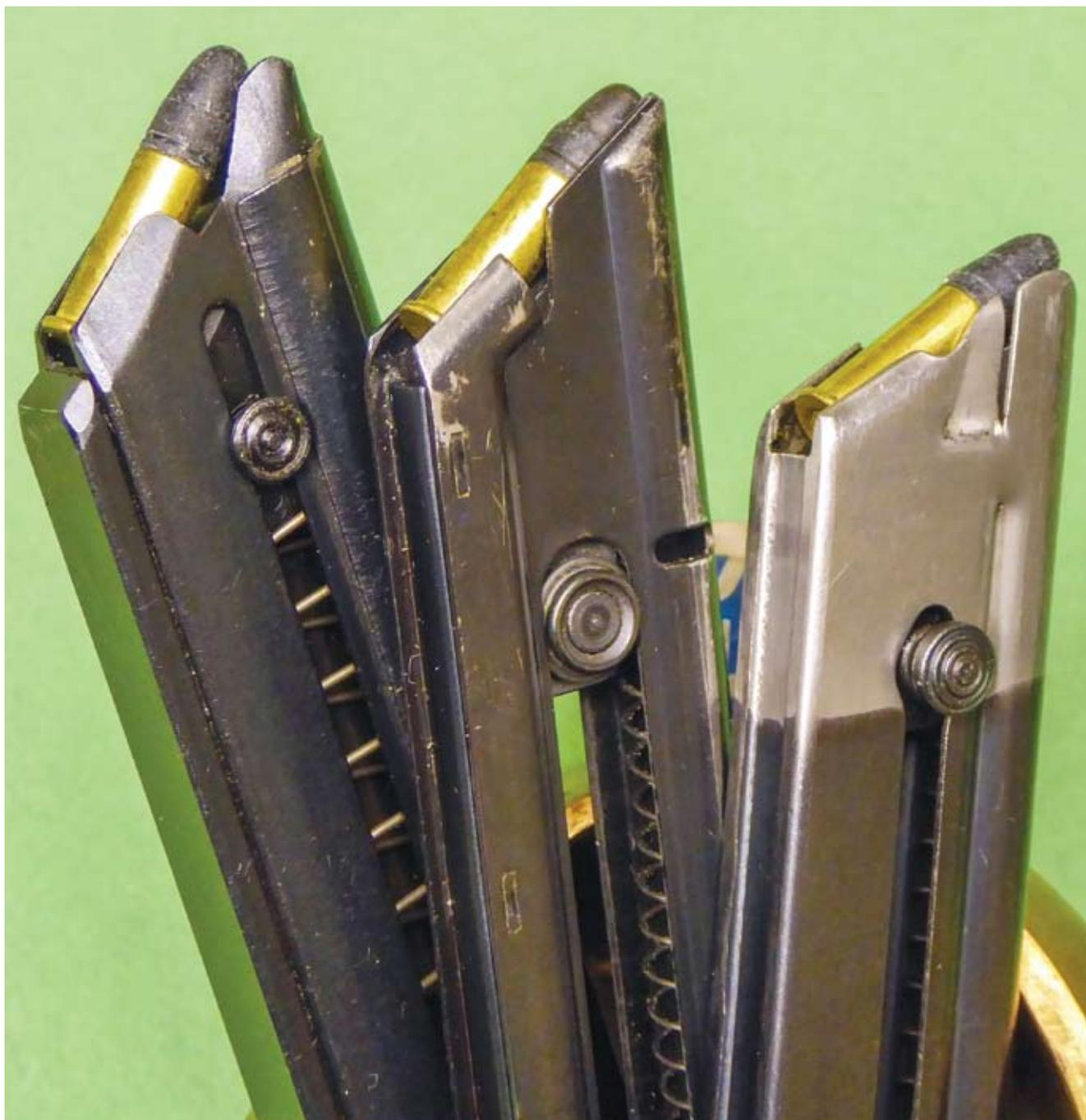
.22lr Magazine von links nach rechts: 1. Magazin für Erma Einstecksystem für P.08 (Luger), 2. Colt Woodsman, Spätere Produktion ca. 1970, 3. Colt The Woodsman 1938. 1. und 2. haben fixe Magazinlippen, das Magazin für 3. hat dazu noch beidseits federnde Elemente, die die Patronenzufuhr der Randpatrone .22lr optimieren sollen.
