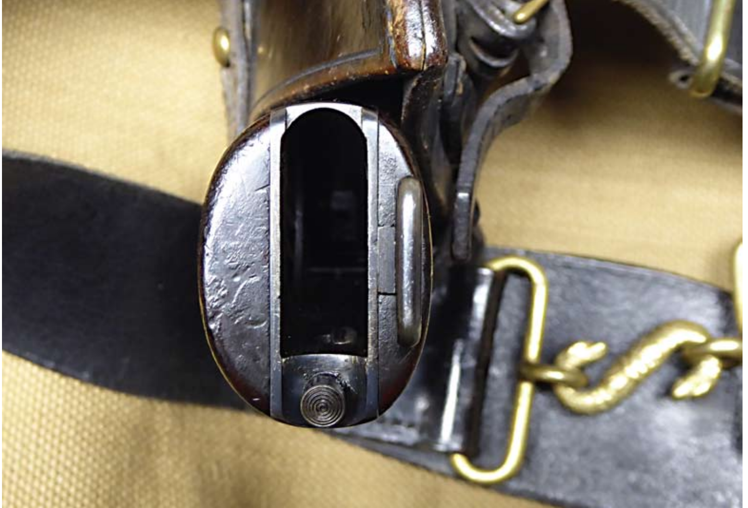
Griff der W&S .38 ACP von unten. Man beachte die bedeutend breitere Griffschale rechts (darunter liegt die mächtige V-Feder) und die schmale Griffschale mit der fixen Fangriemenöse links.
