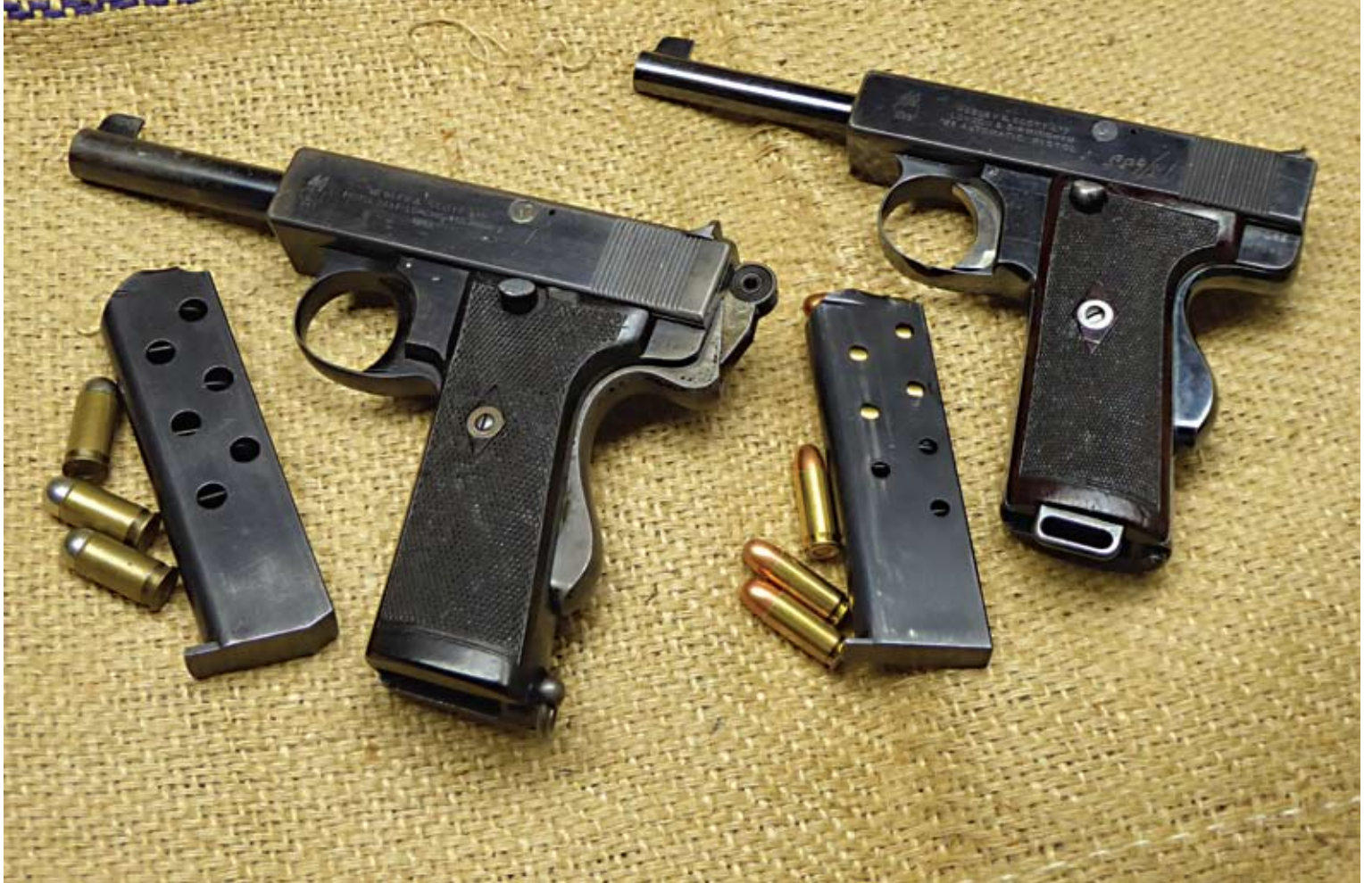
W&S zum Vergleich: links Webley .455 Auto, Mark I rechts der kleine Bruder in .38 ACP mit innenliegendem Hahn
