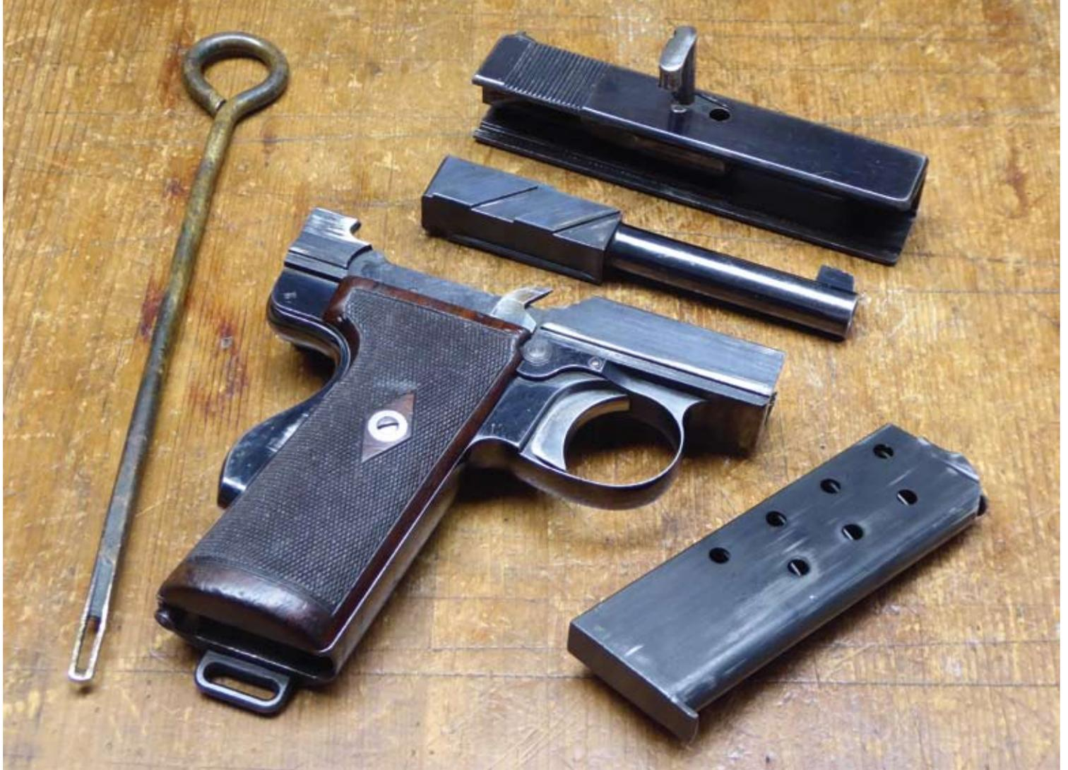
*Zum Reinigen zerlegt. Immer wieder fasziniert die enge Passung und das Fehlen von Werkzeugspuren.*
