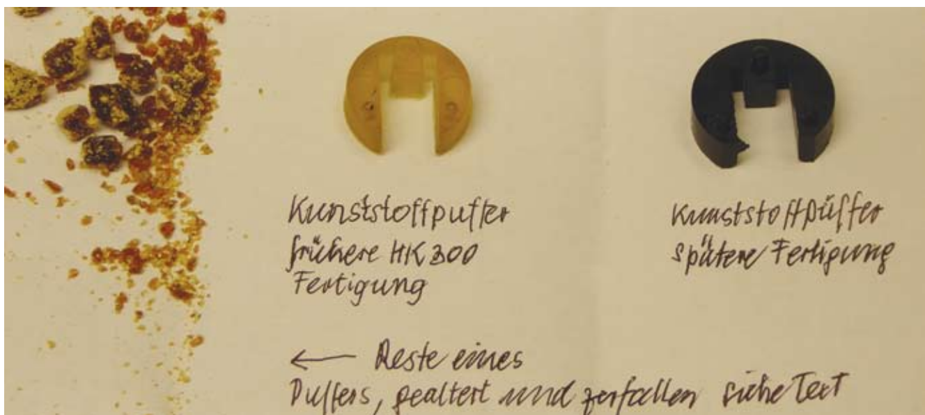
Von links "zerbröselter" alter Puffer, dieser neuwertig, schwarzer Puffer der Letztserie
