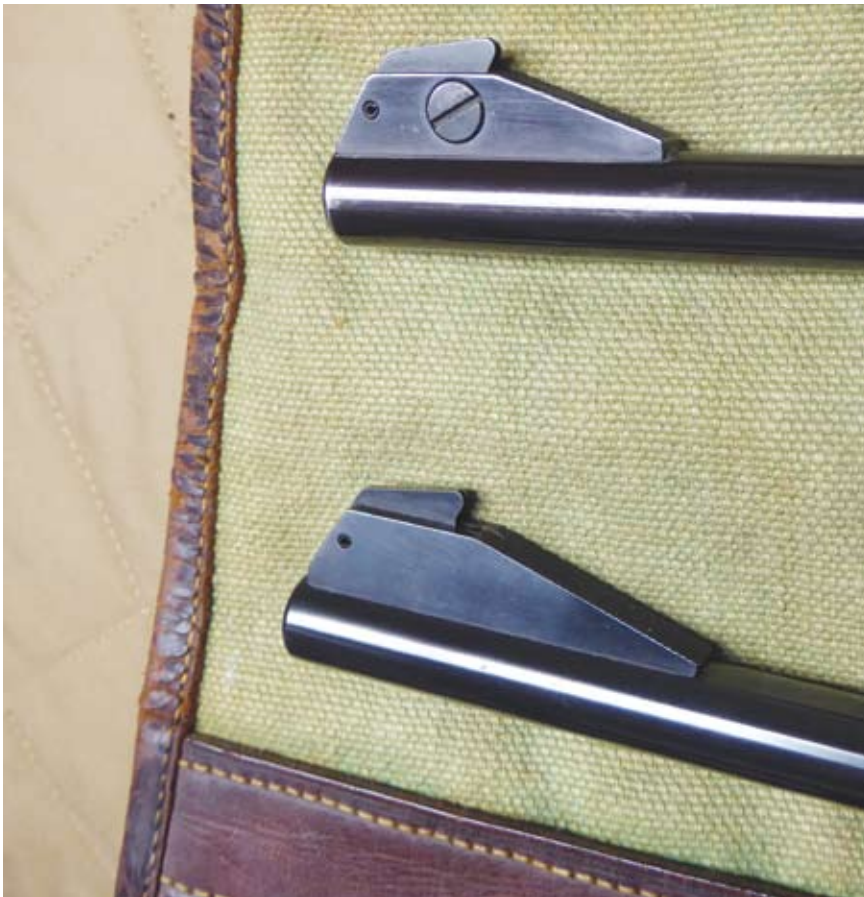
Kornsattel frühe Fertigung, darunter die größere späte Fertigung
