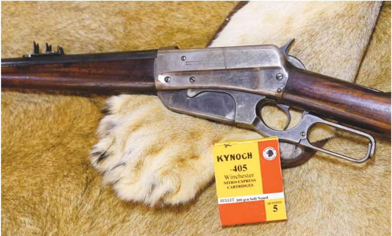
Systemkasten einer Winchester Model 1895 samt fest eingebautem Magazin für übereinanderliegende Patronen im Großwildkaliber .405 Winchester
