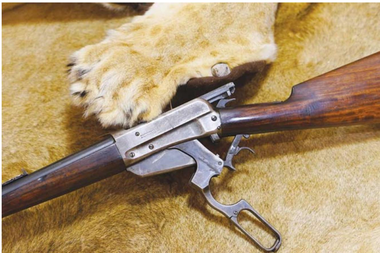
Winchester Model 1895 mit geöffnetem Verschuß (Unterhebelrepetiersystem)
