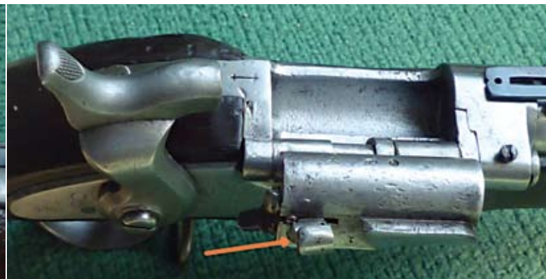
Snider-Aptierung einer 1865 hergestellten Perkussionsbüchse Modell 1861: Verschluß geöffnet, der orange Pfeil zeigt auf den (nicht originalen) Verriegelungshebel.
