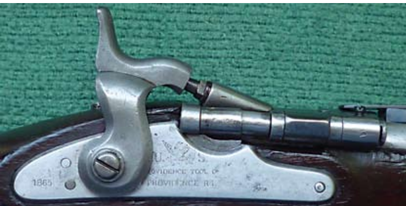
Snider-Aptierung einer 1865 hergestellten Perkussionsbüchse Modell 1861: Sicht auf Schloss; die ursprünglich für den Pistonssockel vorgesehene Ausnehmung wurde vergrößert; ev. um das vollständige Ausklappen des Verschlussblocks zu ermöglichen.
