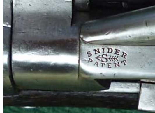
Snider-Aptierung einer 1865 hergestellten Perkussionsbüchse Modell 1861: Sicht von oben auf den Verschuß: Patentbeschriftung. Unten im Bild der (nicht originale) Öffnungshebel.
