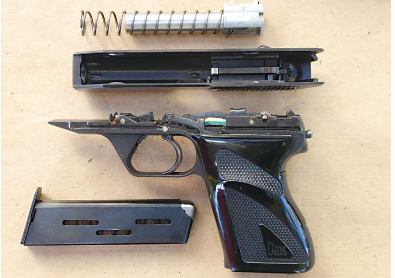
HK 4: Zum Reinigen zerlegt. Die Feder des Laufes endet außen im Bereich des Patronenlagers mit einem Haken in einer Bohrung, um beim Kaliberwechsel immer die richtige Feder zu haben.
