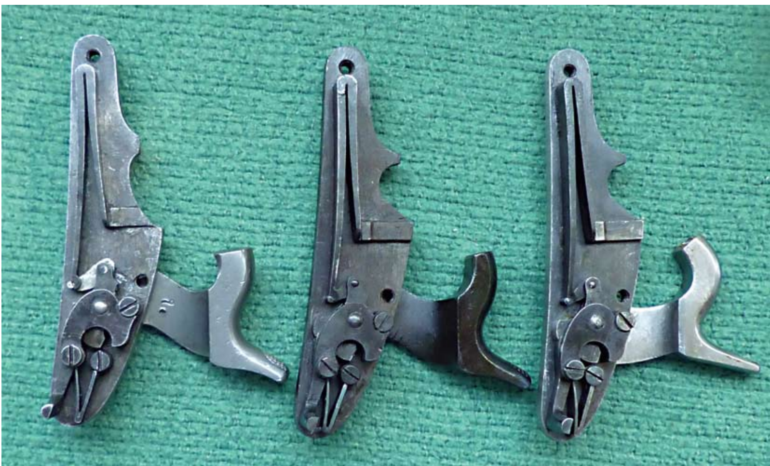
Die Schlosse der drei Gewehre: bei der Snider-Aptierung (links) ist die vergrößerte Ausnehmung am Schloßblech zu erkennen, und die offensichtlich nachgefertigte Kette. Mit Ausnahme der Hähne sind die Teile aber praktisch austauschbar.
