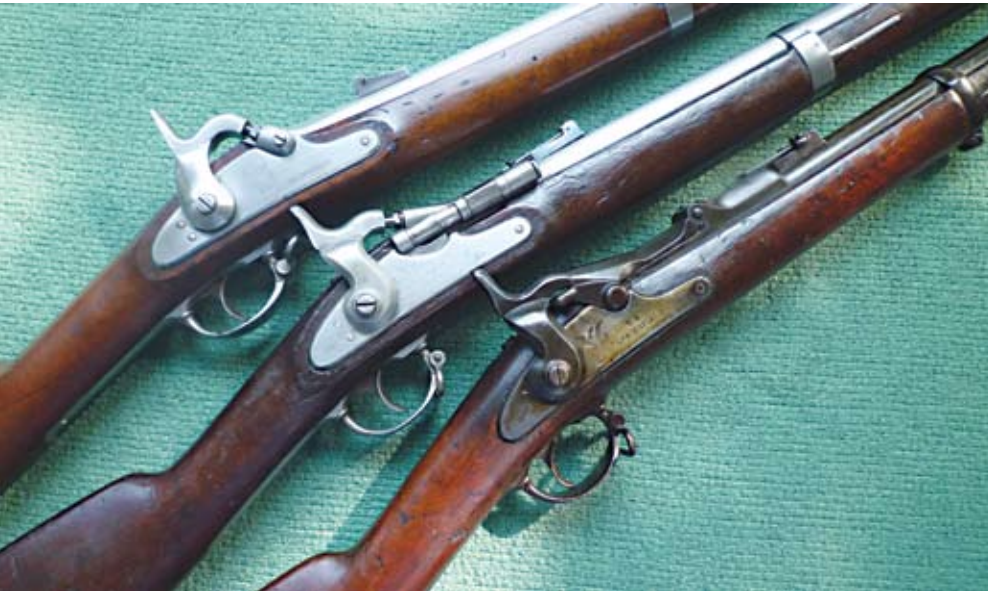
Aptierungen eines Perkussionsgewehrmodells (Springfield Modell 1861, Replika, oben) nach Snider (Mitte) und nach Allin (US-Modell 1868, unten)
