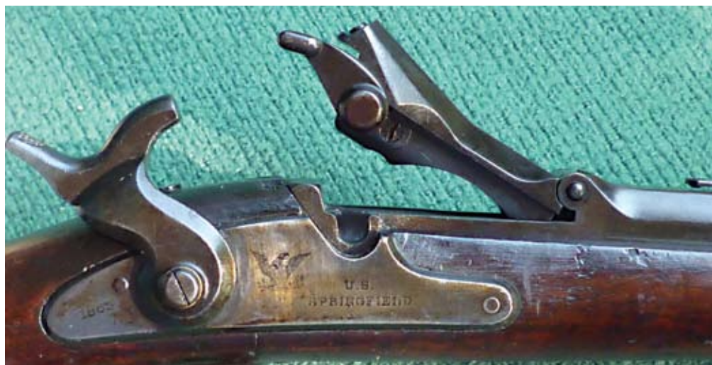
Allin-System, US Modell 1868 (.50-70 Govt.) mit Verwendung von Teilen der Springfield 1861 Büchse. Das Schloß ist mit 1863 datiert. Der Verschuß ist etwas hochgeklappt, der Öffnungshebel deutlich zu sehen.
