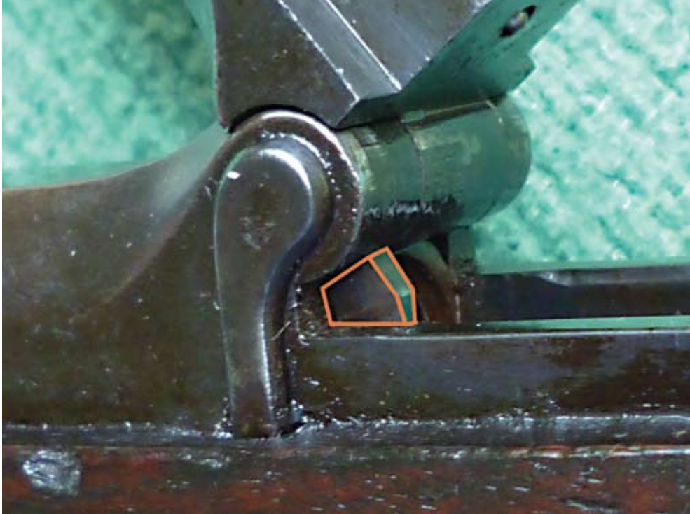
Allin-System, US Modell 1868 (.50-70 Govt.) mit Verwendung von Teilen der Springfield 1861 Büchse. Verschuß geöffnet, der Auszieher ist orange umrandet.
