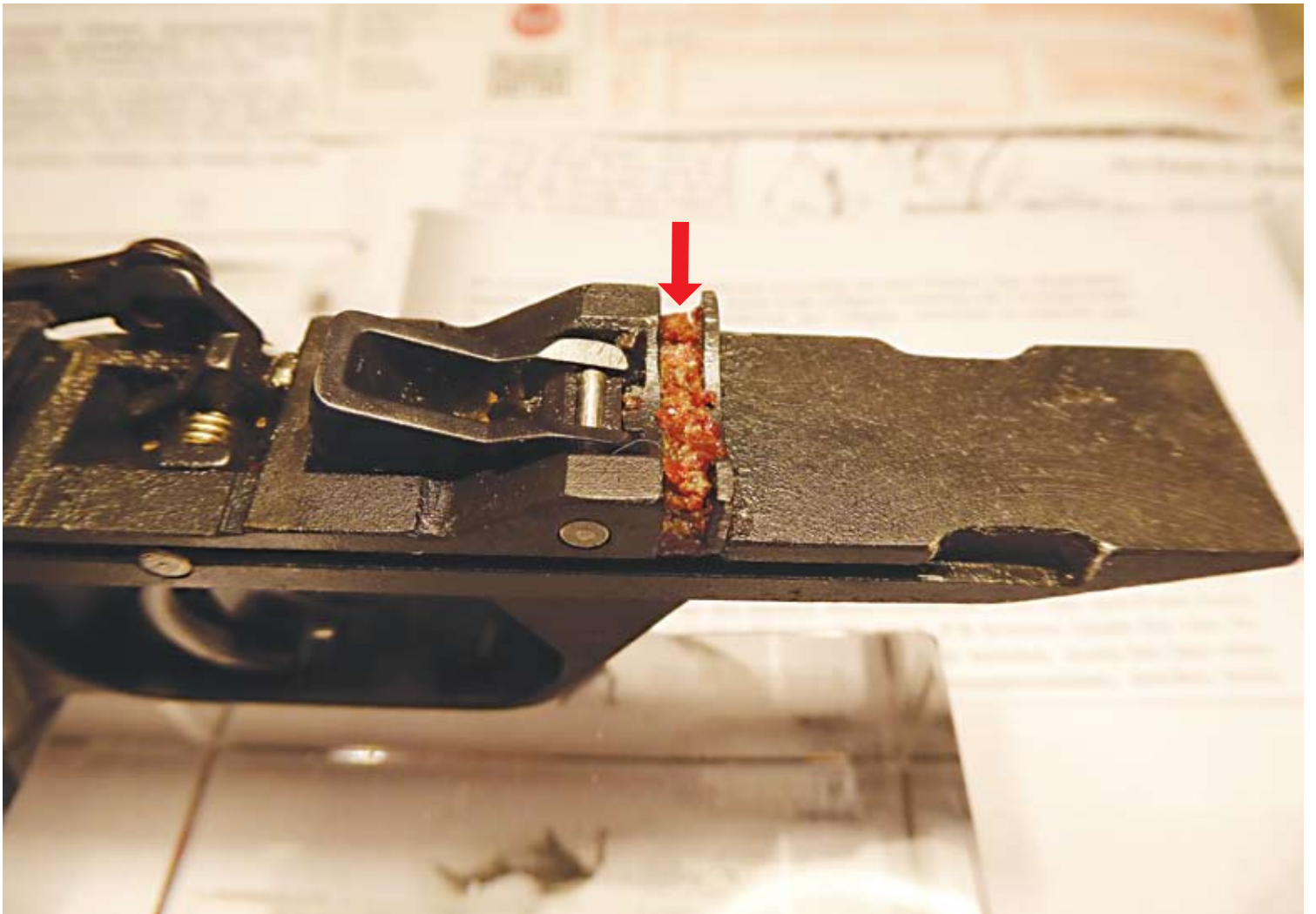
Griffstück von oben mit deutlich zersetztem Rückstoßpuffer (siehe Pfeil)
