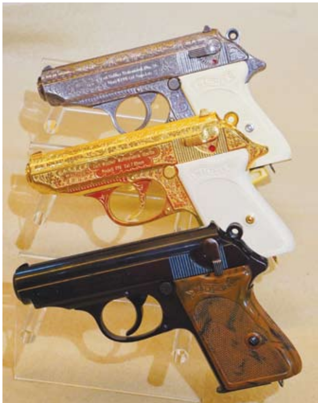
dreimal Walther PPK, von oben nach unten: PPK, Fertigung Ulm, vernickelt, 9mm kurz; PPK vergoldet, Fertigung Ulm, Kaliber 7,65 Browning; PPK brüniert, Fertigung Zella-Mehlis, 90°Sicherung, Kaliber 7,65 Browning
