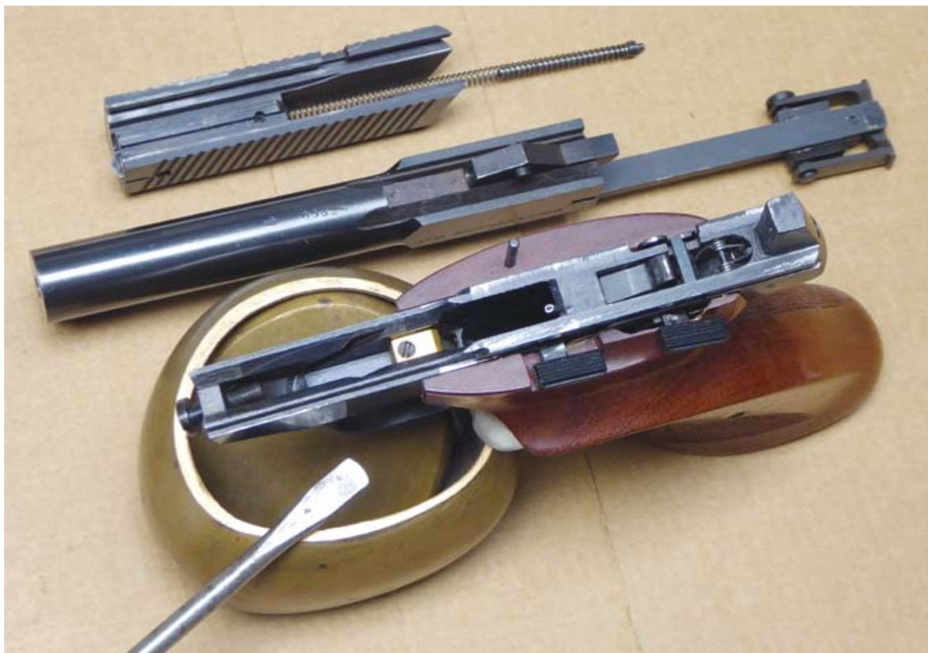
FN Modell 150 zerlegt nach starkem Gebrauch, links vorne Spezialschraubendreher mit konvexer Klinge passend zum konkaven Schlitz der Laufhalteschraube
