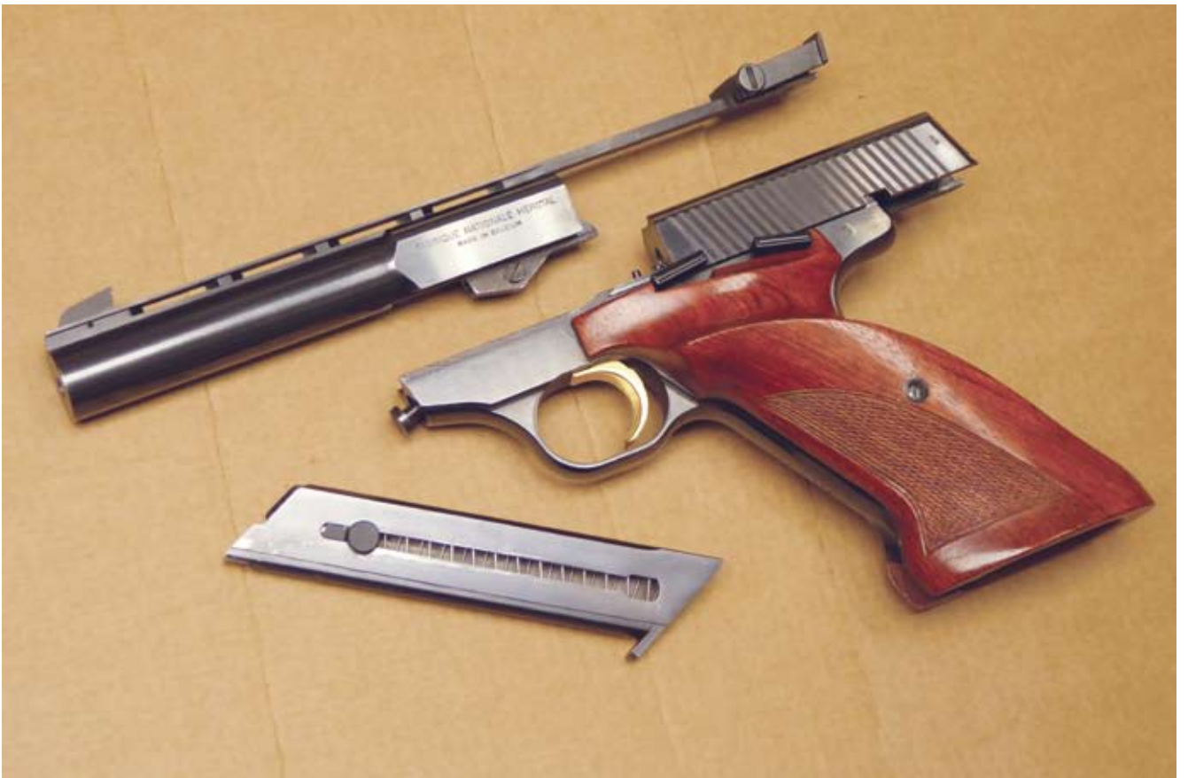
Zum Reinigen zerlegt, Laufhalteschraube verbleibt im Griffstück
