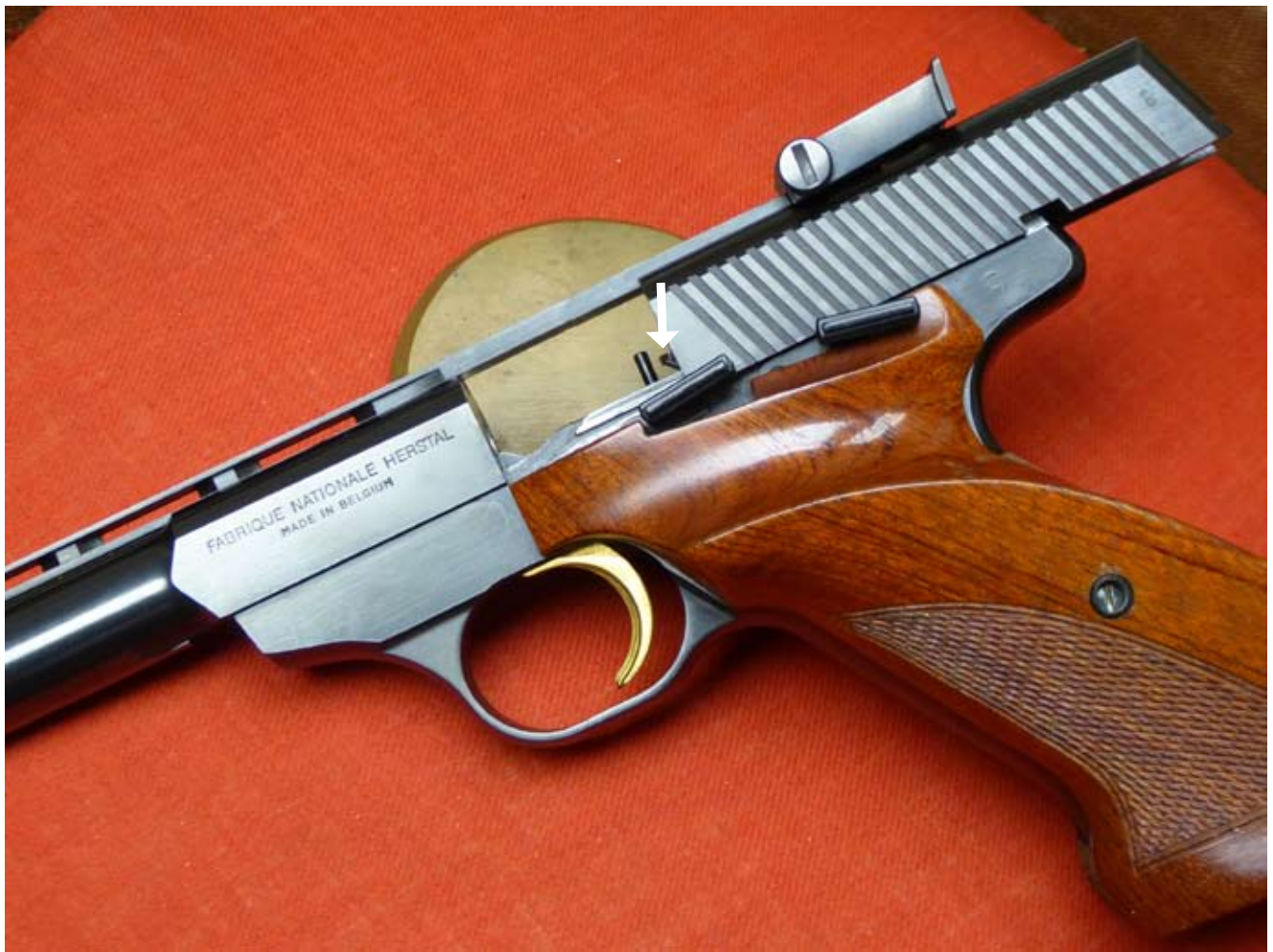
FN Modell von links. Nach letztem Schluß Schlitten in hinterster Stellung fixiert. Hülsenabweiser und Ausstoßer (Pfeil) sichtbar
