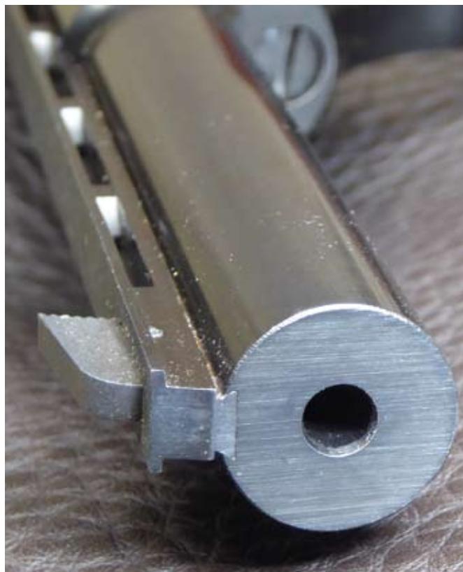
Mündung von Mod. 150, deutlich zu sehen: die aufwendige Verankerung der ventilierten Laufschiene mit dem Patridgekorn, oben die Laufhalteschraube
