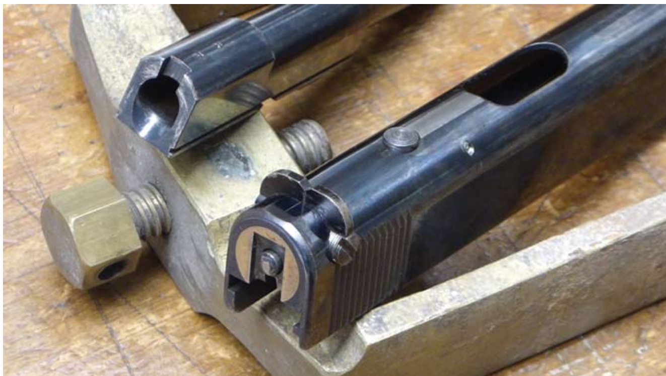
Lauf und Schlitten mit Kimmenverstellung durch Schraube
