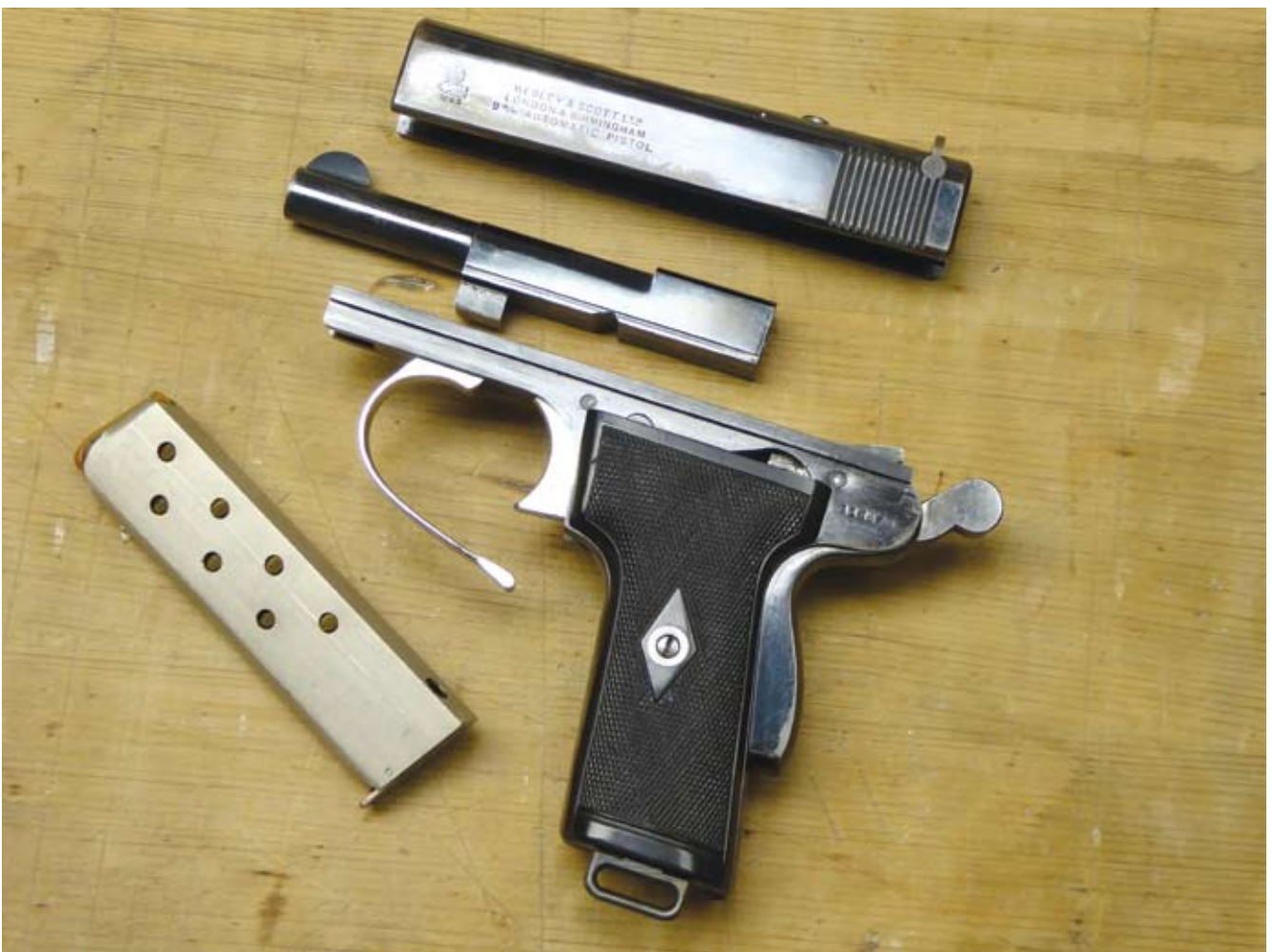
Modell 1909 von links zum Reinigen zerlegt. Abzugsbügel nach unten geklappt.
