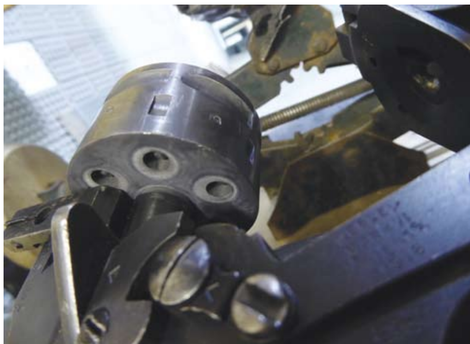
Zylinder von vorne mit asymmetrischen Ablagerungen
