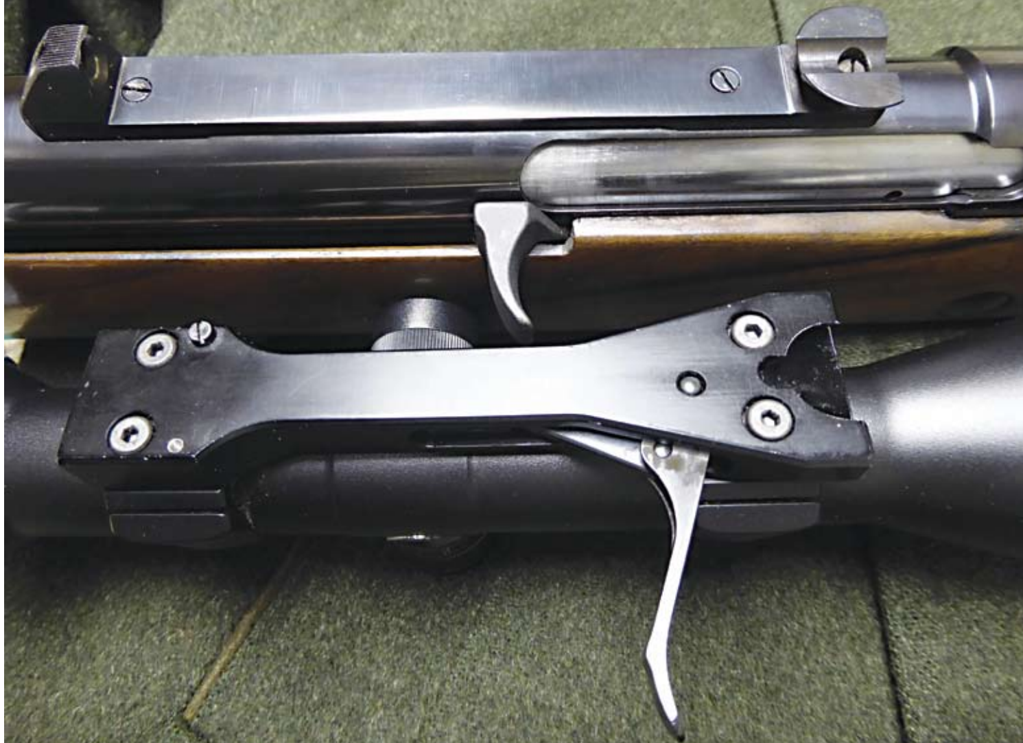
Oben ZF-Basis auf Selbstlader, darunter ZF mit Unterseite der Montage.
