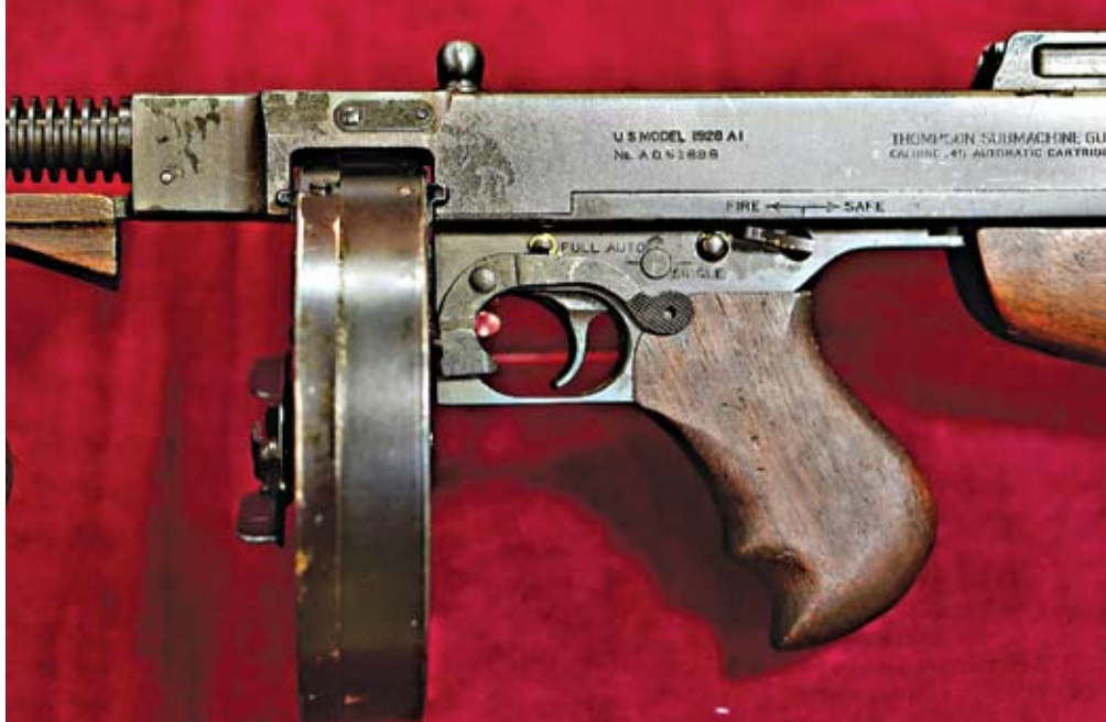
Detailansicht der Thompson Submachine Gun mit nachträglichen Veränderungen. Die Waffe kann nunmehr im halbautomatischen Modus geschossen werden.
