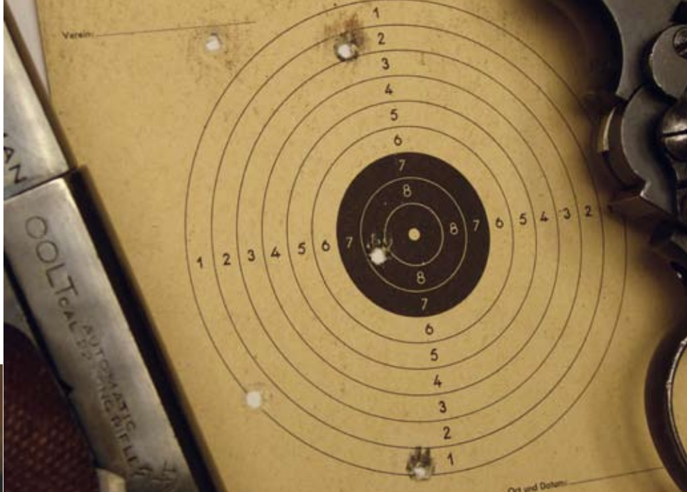
Zielscheibe für Beschußprobe, links Colt kleinerer Einschuß, rechts Einstecklauf größerer Einschuß.
