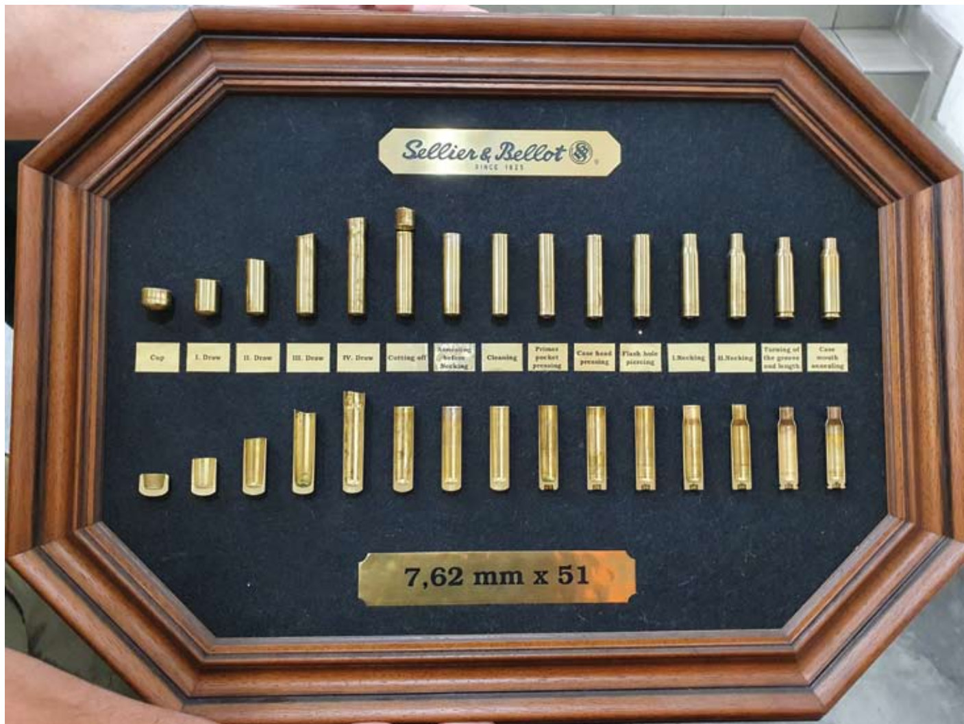
Die Produktionsschritte einer Hülse für eine Zentralfeuerpatrone
