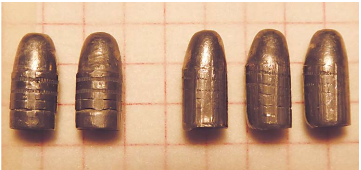
links 2 gerade Colt Projektile, rechts 3 Geschosse vom Einstecksystem mit nach rechts gebogener Spitze
