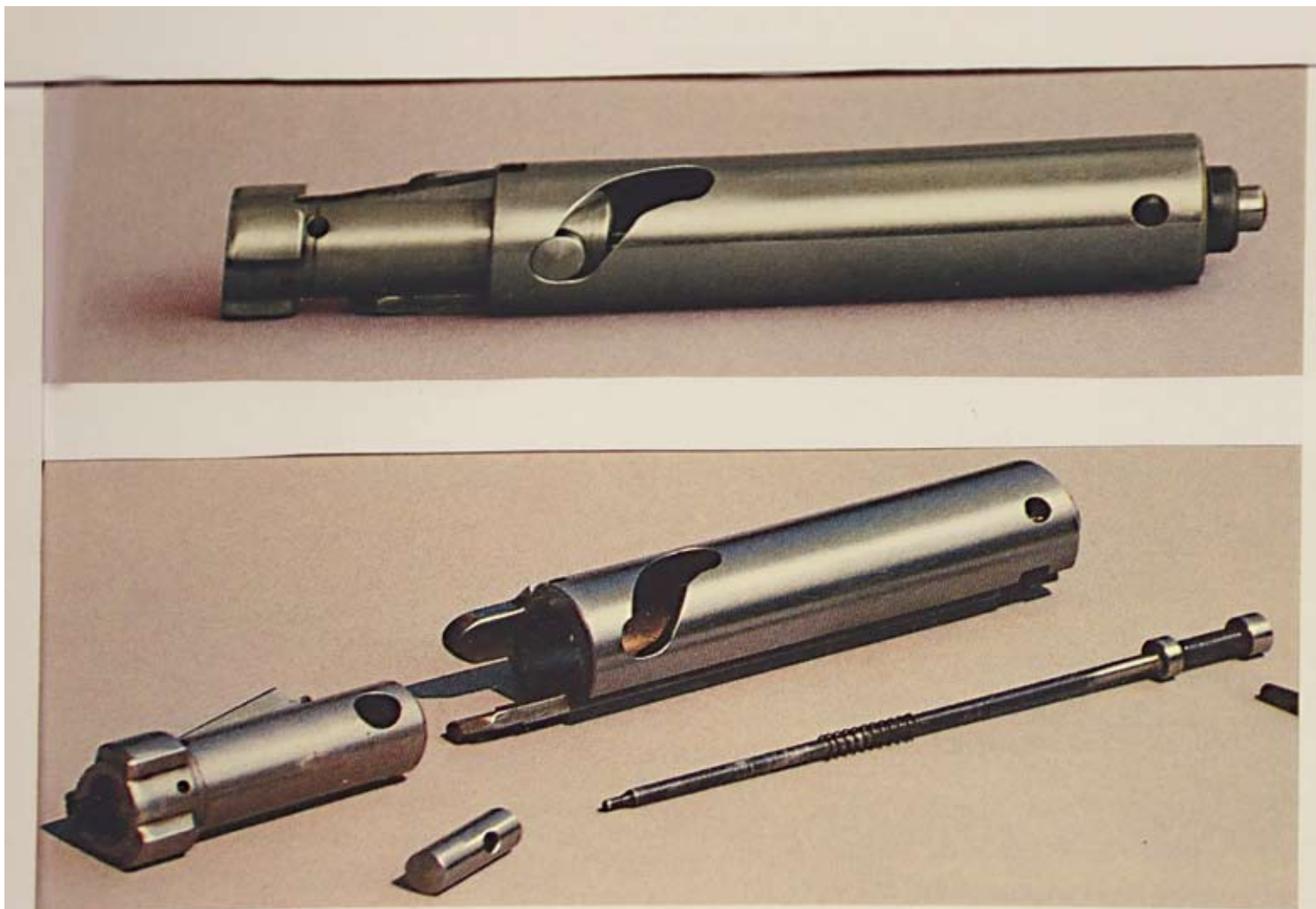
Oben: Verschluß mit Steuerkurve, darunter Verschlußkopf, Verschlußträger, Steuerbolzen und Schlagbolzen.
