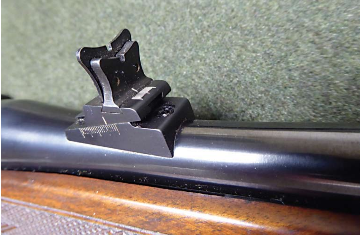
Erhöhte Kimme wegen Montagebasis für ZF
