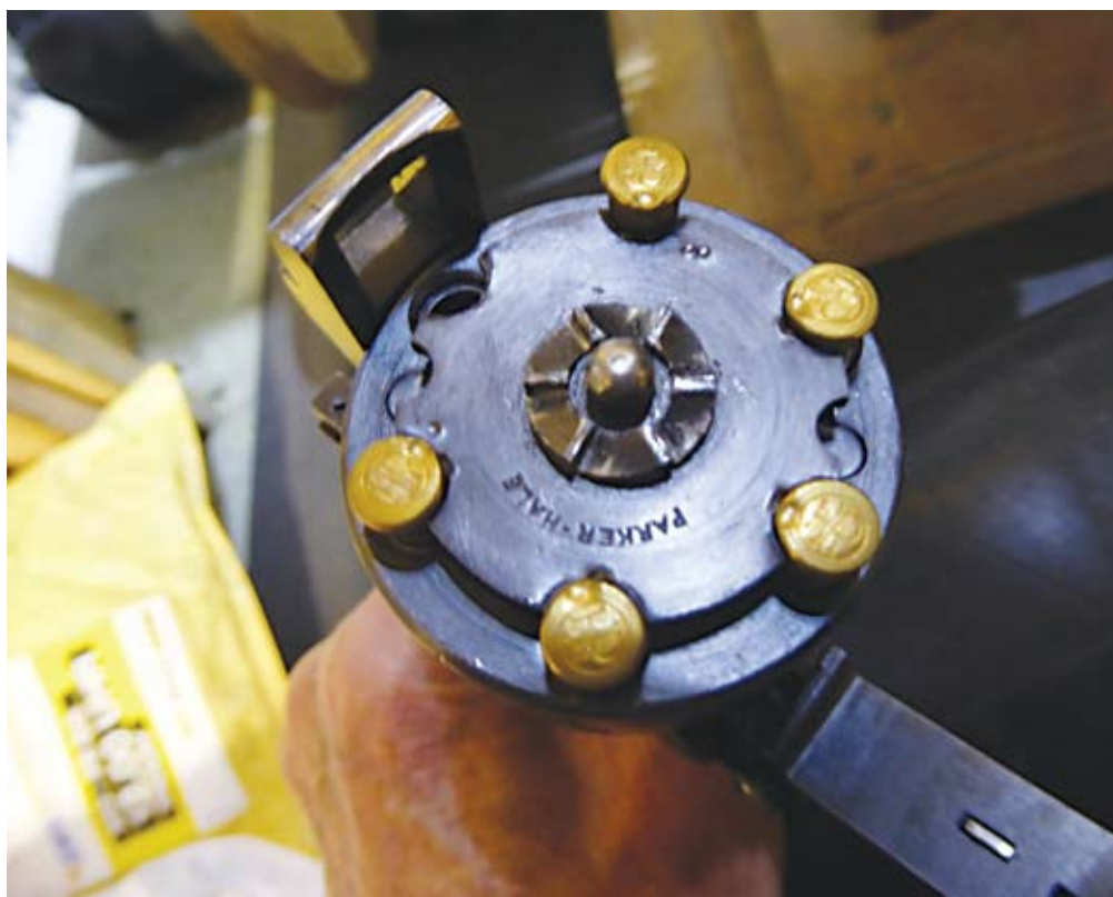
Zylinder des Einstecksystems mit durch Auszieher gehobenen Hülsen, dies bombiert
