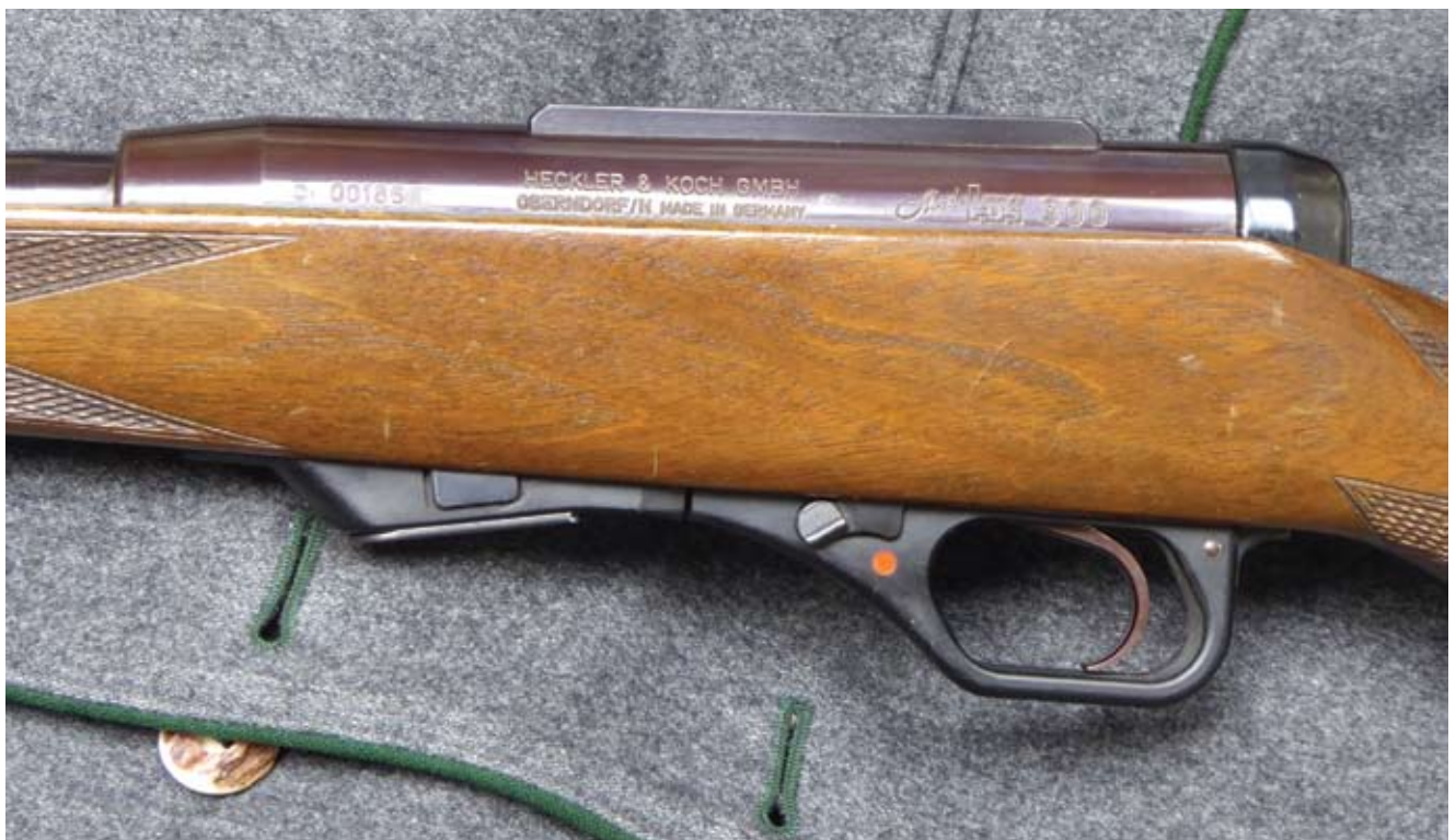
Frühes HK 300 von links, Verschlussbüchse aus Spezialstahl, der die Brünierung nicht voll annimmt. ("plautenfarbig")
