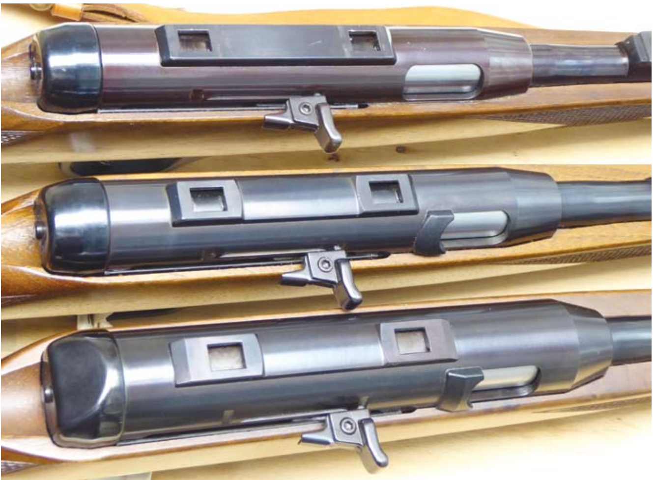
Von oben: frühes Modell (pflaumenfarben) erste ZF-Basis. Mitte: spätere ZF-Basis, Auswurföffnung mit Hülsenabweiser. Unten: letzte Modellvariante in allen Dimensionen vergrößert, ZF-Basis aber gleich
