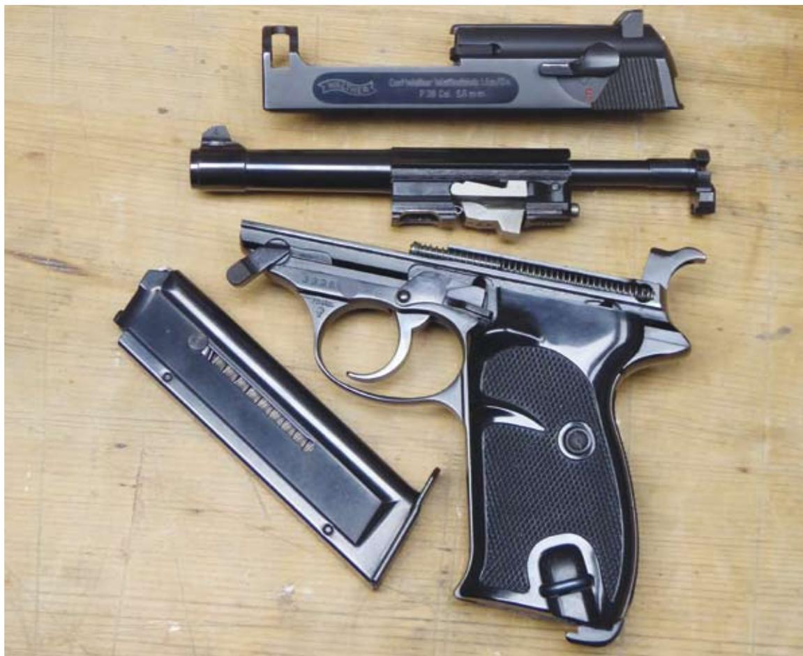
Original P38 Griffstück, darüber 9mm-Lauf mit teilweise eingestecktem KK-Lauf, oben Verschluss des Einstecksystems
