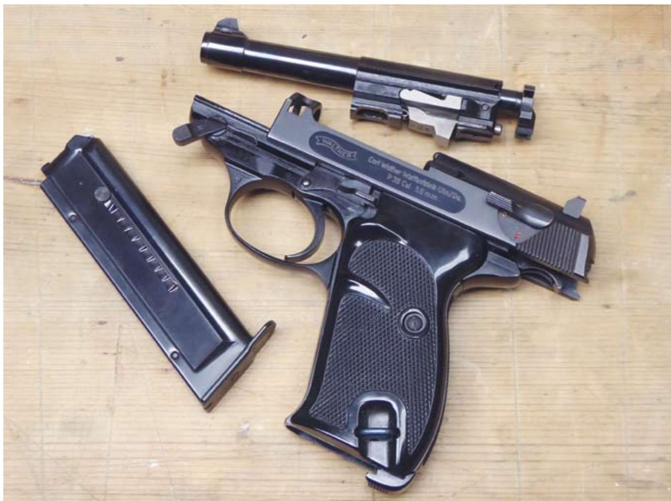
P38 Griffstück mit dem KK-Schlitten. Darüber P38 Lauf mit fast ganz eingeführtem KK-Lauf
