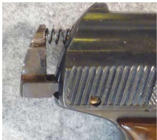
Abb. 7: Pistole EUSTA P7. Durch die im Bereich der Spannrielen sichtbare Bohrung im Schlitten kann ein Bolzen eingedrückt werden, womit das Schlagbolzenfedergegenlager entriegelt wird und aus dem Griffstück austritt.
