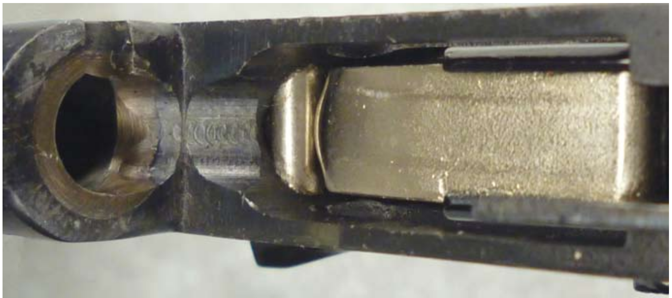
Abb. 14: Blick auf die eher grob gearbeitete Zuführungsrampe. Der Zubringer ist etwas abgesenkt. Der querlaufende Stahlbolzen ist wohl als Griffstückverstärkung gedacht.
