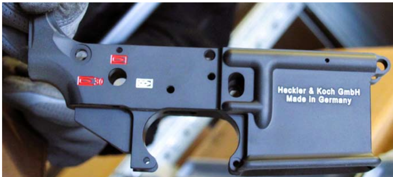
Dieser Lower wird nicht nur ein „wesentlicher Bestandteil“, sondern auch Kriegsmaterial - Vollautomatik-Symbol und Bohrung für die Automatikwelle.
