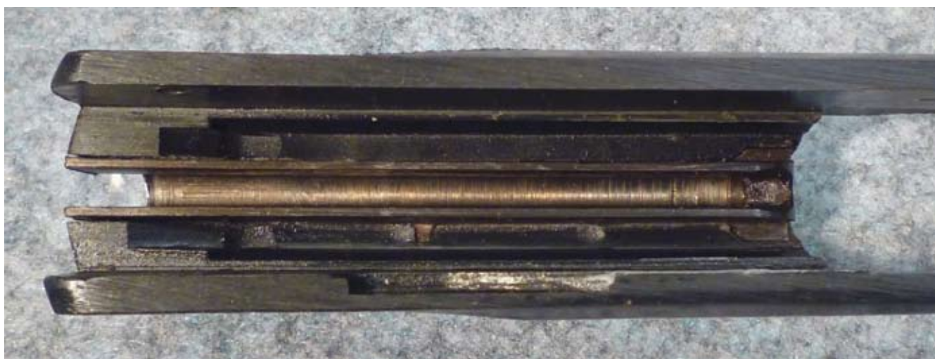
Abb. 10: Blick auf Stoßboden und Schlagbolzenführung aus Stahl. Zwischen der Stahleinlage und dem Hinterende des Schliittens befindet sich ein Spalt.
