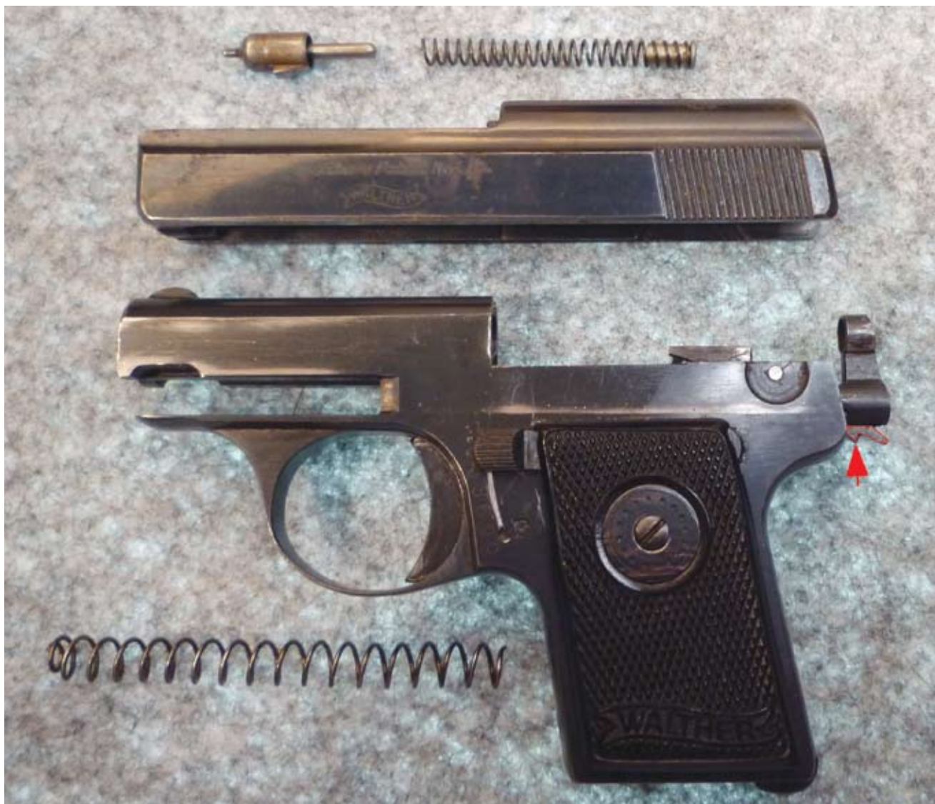
Abb. 4: Walther Modell 9, zum Reinigen zerlegt. Nach Hochdrücken des Hebelchens an der Rückseite des Griffstücks tritt das Schlagbolzenfedergegenlager aus dem Griffstück. Der Hebel und die Raste, die im Griffstück verriegelt, sind rot umrandet.
