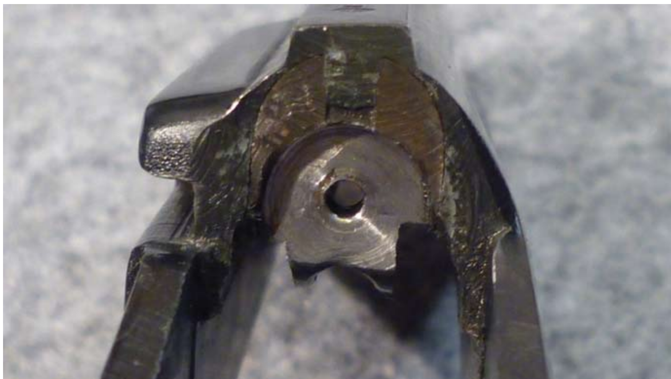
Abb. 9: In den Schliitten ist eine Stoßboden-Schlagbolzenführungseinheit aus Stahl eingegossen. Deutlich sichtbar sind die groben Bearbeitungsspuren im Stoßbodenbereich.
