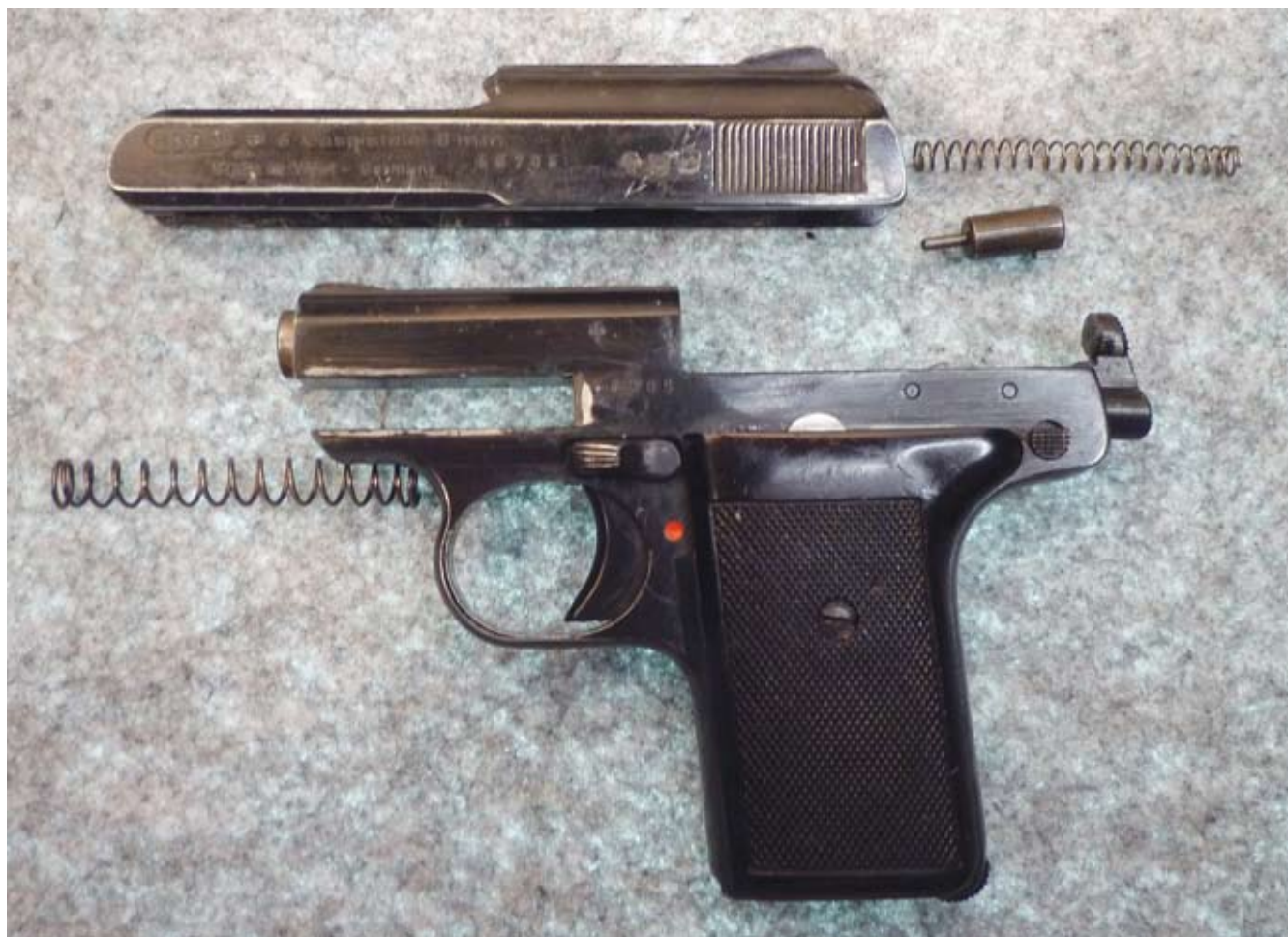
Abb. 6: Pistole Reck P6, zum Reinigen zerlegt.
