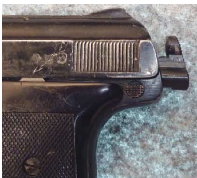
Abb. 5: Bei der Pistole Reck P6 (und P8) wird durch Druck auf einen geriffelten Knopf hinter der linken Griffschale das Schlagbolzenfedergegenlager entriegelt und tritt aus dem Griffstück vor.
