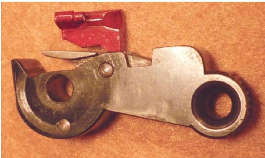
Bild 5: Lage des Hahnsperrstücks (rot eingefärbt) zum Hahn in Sperrstellung (Hahnweg wird blockiert)
