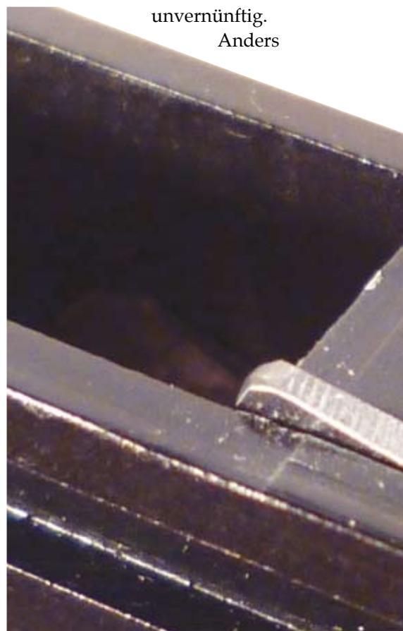
Bild 6: Hahnsperrstück im Griffstück versenkt (aktiv), links davon ist der Entspann-
