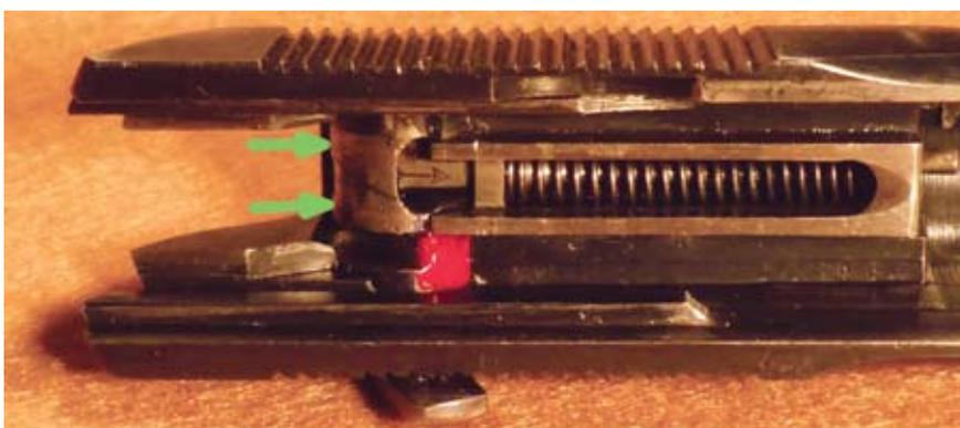
Bild 2: Schlagbolzen und Sicherungswelle, Waffe gesichert. In dieser Stellung des Sicherungshebels wird das hintere Ende des Schlagbolzens links und rechts von der Sicherungswelle so flankiert, daß beim Abschlagen des Hahns der Schlagbolzen nicht mehr berührt wird (grüner Pfeile). Der Schlagbolzen wird zusätzlich von der Sicherungswelle arretiert. Eine Nase an der Sicherungswelle (rot eingefärbt) drückt das Entspannstück im Griffstück nieder.
