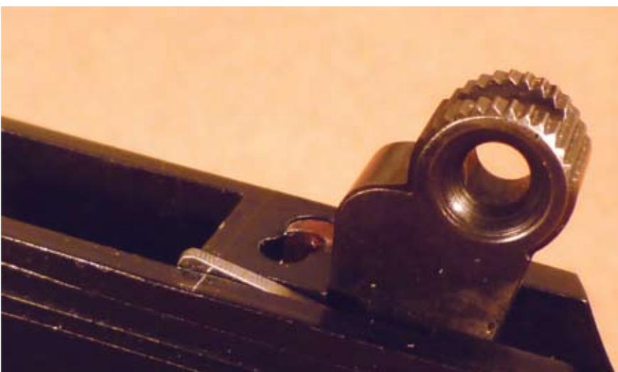
Bild 8: Hahnsperrstück inaktiv; es schließt dabei bündig mit der Griffstückoberseite ab
