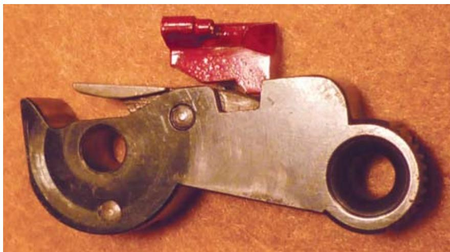
Bild 7: Lage des Hahnsperrstücks (rot eingefärbt) zum Hahn in inaktiver Stellung (Sperrstückfortsatz liegt in Ausnehmung des Hahns)
