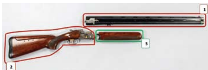
Abbildung 8: Bockdoppelflinte, Hauptbestandteile der Waffe
