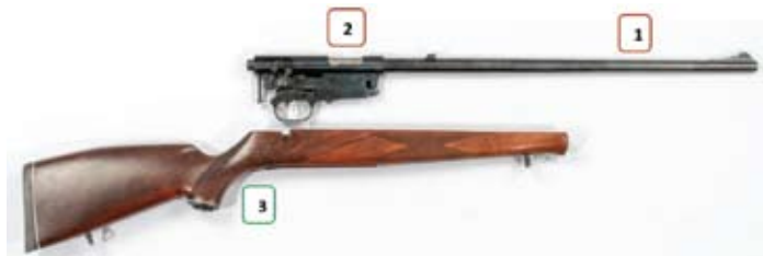
Abbildung 15: Repetierbüchse, Hauptbestandteile der Waffe
