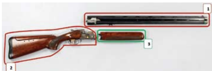
Abbildung 8: Bockdoppelflinte, Hauptbestandteile der Waffe
