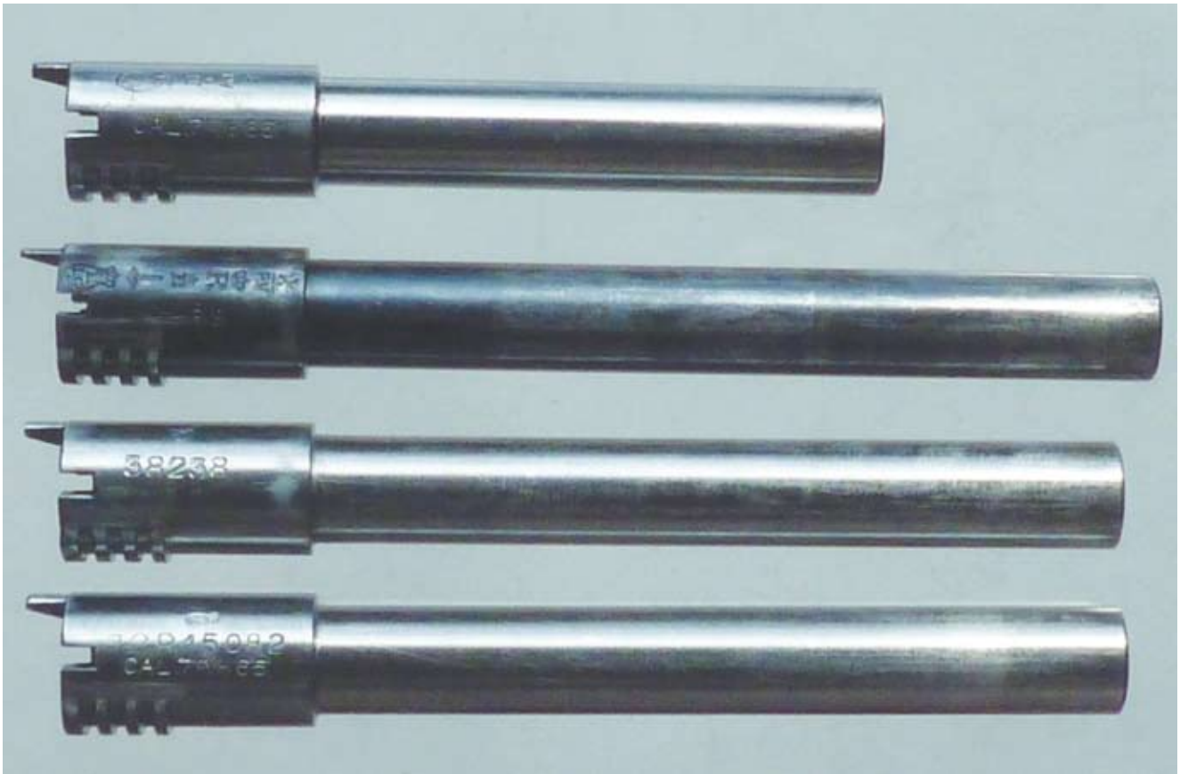
Läufe der FN 1910 (Normallänge und verlängerter Lauf), FN 1922 und FN 130 (von oben nach unten)
