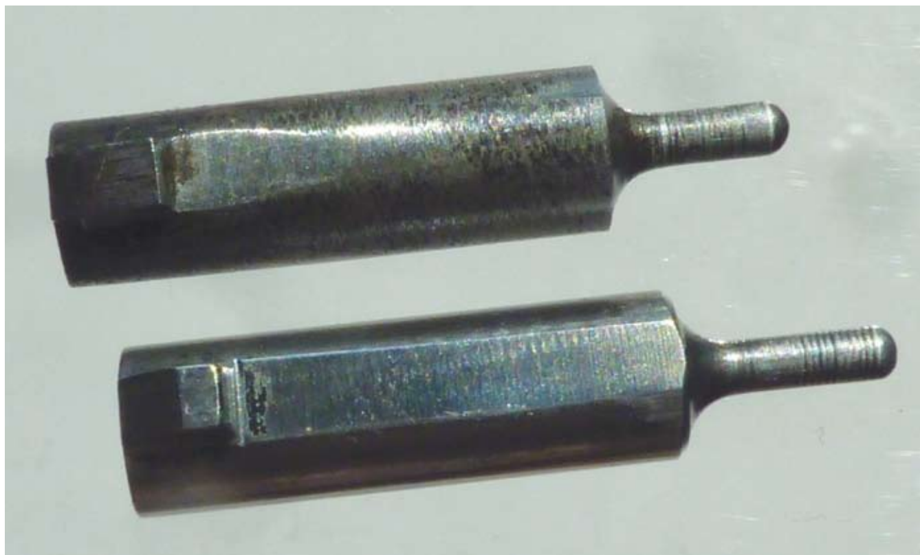
Schlagbolzenunterseite oben: FN mit verlängertem Lauf; unten: spätere Fertigungen der FN 1910, FN 1910/22 und der FN 100er Reihe.
