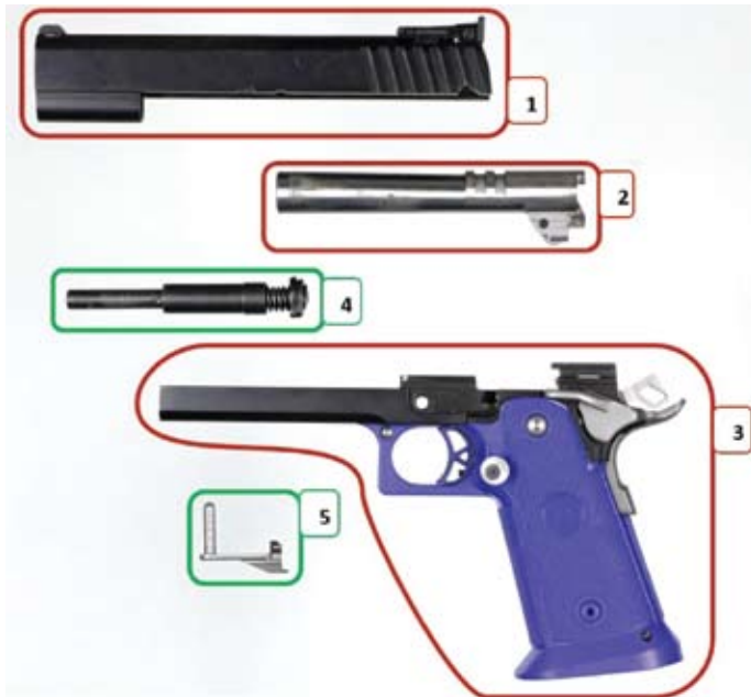
Abbildung 33: STI 2011, Hauptbestandteile der Pistole
