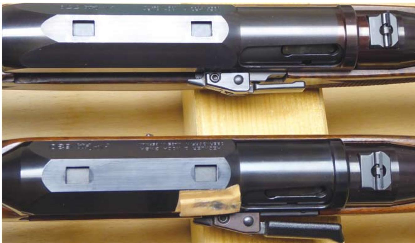
HK 770 mit Ladehebel der frühen Produktion darunter der verbesserte Ladehebel der späteren Serie bei HK 630. Das von mir angebrachte Pflaster mit Kunststoffeinlage verhindert die Deformation der kraftvoll herausgeschleuderten Hülsen und den Messingabrieb am Oberteil.
