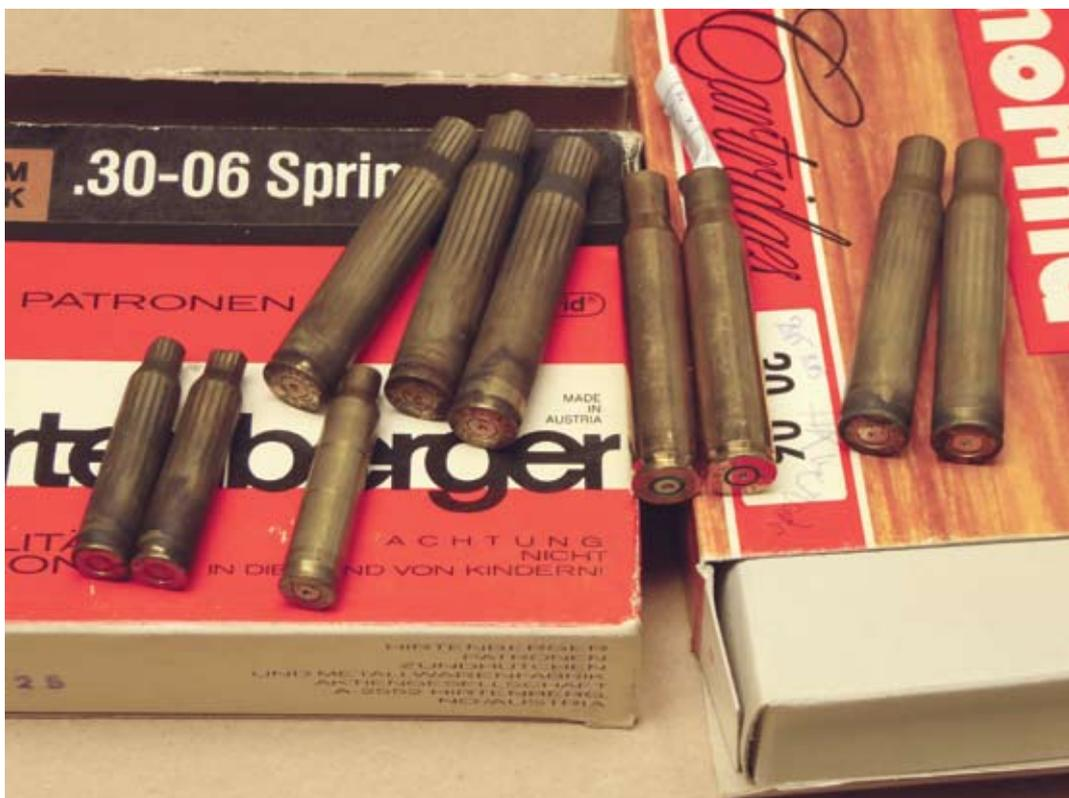
Patronenhülsen .223 und .30-06 aus HK 630 und HK 940 mit deutlichen Spuren der Entlastungsrillen. Die glatten Hülsen aus herkömmlichen Patronenlagern.
