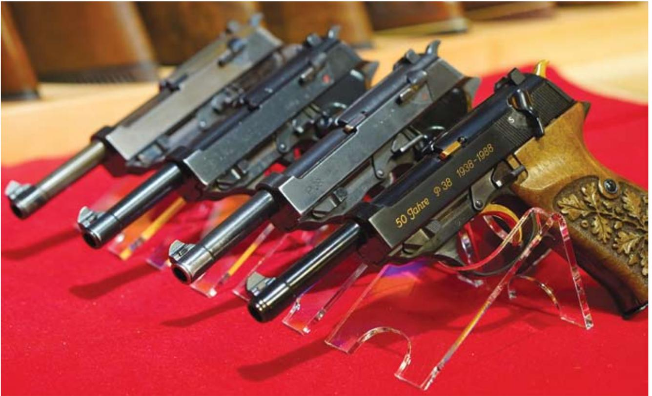
Vier (Walther-)Pistolen P.38 (von hinten nach vorne): P.38 Fertigung in der NS-Zeit mit WaA Stempel · P.38 Fertigung in der NS-Zeit mit WaA Stempel und Eigentumsstempel des Österr. Bundesheeres · P.38 Fertigung in der NS-Zeit, Zusammenbau unter französischer Besatzung und Eigentumsstempel des Österr. Bundesheeres · P.38 Jubiläumsmodell 1938-1988, Nachkriegsfertigung
